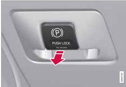
Feststellbremsregler - lösen.
