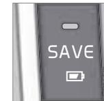
Diese Funktion startet das Aufladen der Hybridbatterie und sorgt dafür, dass deren Energieniveau eine Kapazität nicht unterschreitet, die einer mit Elektroenergie betriebenen Fahrt von etwa 20 km
