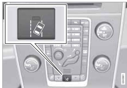
Das Ein- und Ausschalten dieser Funktion erfolgt mit einer Taste in der Mittelkonsole. Eine Lampe in der Taste leuchtet, wenn die Funktion eingeschaltet ist.
