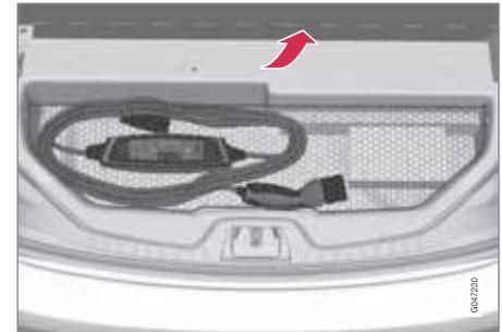
Das Ladekabel ist im Staufach unter der Bodenabdeckung des Gepäcksraums verstaut.
