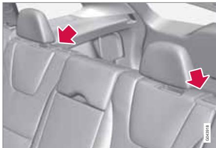
Zugschlaufen zum Hochziehen des Netzes.
