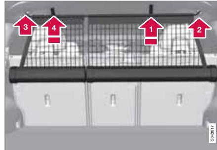
Das Netz wird aus den Kassetten herausgezogen und arretiert automatisch nach etwa einer Minute, wenn die Rückenlehnen der Rücksitzbank hochgeklappt sind.
