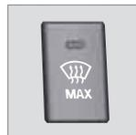
Wird verwendet, um schnell etwaigen Beschlag und Eis an der Windschutzscheibe und an den Seitenscheiben zu entfernen. Luft strömt zu den Scheiben. Die Lampe in der Entfroster-taste leuchtet,
