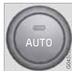
Die Autofunktion regelt automatisch Temperatur, Klimaanlage, Gebläsegeschwindigkeit, Umluftfunktion und Luftverteilung.
