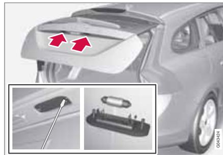
1. Die Schrauben mit einem Schraubendreher lösen.
