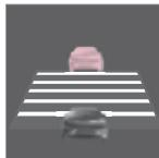
Nur wenn das Display das Bild eines anderen Fahrzeugs zeigt, wird der **Abstand** zum vorausfahrenden Fahrzeug durch den Tempomat reguliert.
