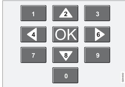
Die Navigation im eigenen Menü der DVD-Video-Disc erfolgt über die Zahlentasten in der Mittelkonsole gemäß der Abbildung oben.
