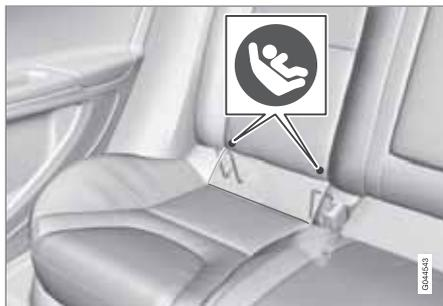
Die Befestigungspunkte für das ISOFIX-Befestigungssystem sind hinter dem unteren
