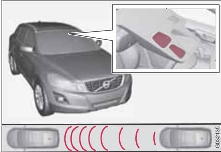
Sender- und Empfängerfenster des Lasersensors<sup>1</sup>.
