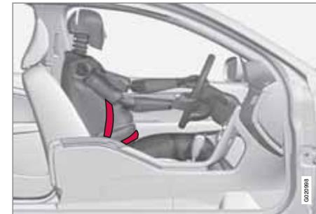
Während der Schwangerschaft muss der Sicherheitsgurt immer angelegt werden. Dabei ist es von äußerster Wichtigkeit, dass er korrekt angelegt wird. Der Sicherheitsgurt muss dicht an der Schulter anliegen, der Diagonalteil des Sicherheitsgurtes muss zwischen den Brüsten zur Seite des Bauches geführt werden.
