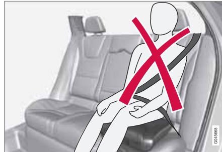
Falsche Position, die Kopfstütze muss auf derselben Höhe platziert sein wie der Kopf und der Gurt darf nicht unterhalb der Schulter verlaufen.
