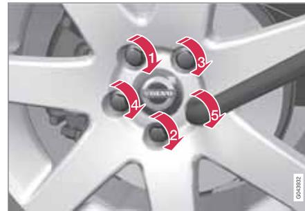
4. Die Radschrauben über Kreuz festziehen. Es ist wichtig, dass die Radschrauben ordentlich festgezogen werden. Mit 140 Nm festziehen. Das Anzugsdrehmo-
