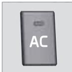
Bei dem Antriebsmodus PURE<sup>1</sup> ist **AC** standardmäßig abgeschaltet.
