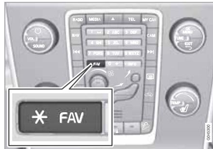
Mit Hilfe der **FAV**-Taste können oft verwendete Funktionen gespeichert werden, so dass diese einfach durch Drücken von **FAV** gestartet werden können. Für jede der folgenden Funktionen kann ein Favorit (beispielsweise **Equalizer**) gewählt werden:
