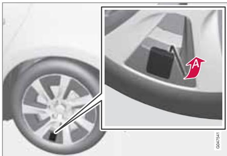
Schlauch des Kompressors mit am Ventil anbringen.
