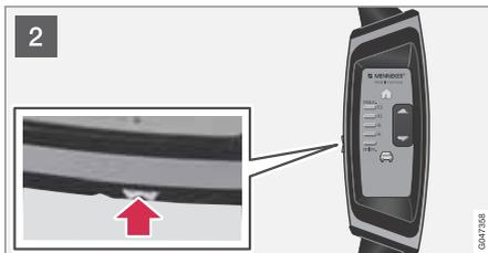
2 Kontroll- und Schutzgerät mit dessen Schalter Aus/(Off) abschalten.
