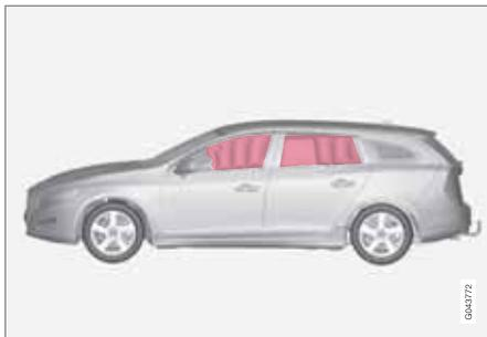
Der Kopf-/Schulterairbag IC (Inflatable Curtain) ist ein Teil von SIPS und Airbags. Der Kopf-/Schulterairbag ist im Dachhimmel entlang der Seiten des Fahrzeugs verborgen. Er schützt die Insassen auf den Außenplätzen des Fahrzeugs. Bei einem ausreichend starken Aufprall reagieren die Sensoren und der Kopf-/Schulterairbag wird aufgeblasen. Der Kopf-/Schulterairbag verhindert, dass der Kopf von Fahrer oder Beifahrer im Falle eines Aufpralls gegen die Innenseite des Fahrzeugs stößt.
