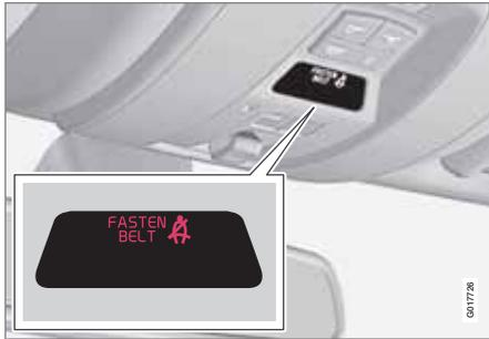
Insassen, die ihren Sicherheitsgurt nicht angelegt haben, werden durch ein akustisches und ein optisches Signal darauf aufmerksam gemacht, den Sicherheitsgurt anzulegen. Das akustische Signal ist geschwindigkeitsabhängig und in bestimmten Fällen zeitabhängig. Das optische Signal befindet sich
