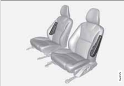
Bei einem Seitenaufprall wird ein Großteil der Aufprallstärke von SIPS (Side Impact Protection System) auf Träger, Säulen, Boden, Dach und andere Teile der Fahrzeugkarosserie übertragen. Die Fahrer- und Beifahrerseite-airbags schützen den Brustkorb und die Hüfte und sind ein wichtiger Bestandteil von SIPS.
