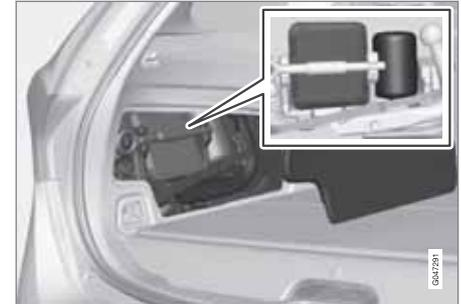
Die Lampen werden zugänglich, indem der Reifenabdichtsatz herausgenommen wird.
