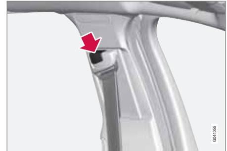
Höhenverstellung des Sicherheitsgurtes. Die Taste drücken und den Gurt in der Höhe verstellen. Den Gurt so hoch wie möglich positionieren, ohne dass er am Hals scheuert.
