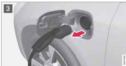
3 Kabel vom Stromanschluss des Fahrzeugs lösen und Klappe schließen, siehe Seite 323.
