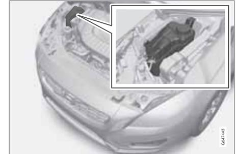
Beim Einfüllen sind die Anweisungen auf der Verpackung zu befolgen. Es ist wichtig, die Kühlmittel-/Wassermenge an die herrschenden Witterungsbedingungen anzupassen. Niemals nur Wasser nachfüllen. Die Gefriergefahr erhöht sich bei zu niedrigem bzw. zu hohem Kühlmittelanteil.
