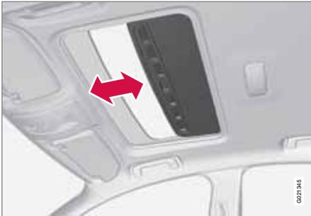
Mit einem langen Druck auf die Verriegelungstaste werden das Schiebedach und sämtliche Fenster geschlossen, siehe Seiten 52 und 65. Die Türen und die Heckklappe werden verriegelt. Wenn der Schließvorgang unterbrochen werden muss, erneut auf die Verriegelungstaste drücken.
