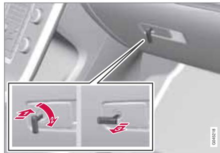
Das Handschuhfach kann nur mit dem abnehmbaren Schlüsselblatt des Transponderschlüssels verriegelt/entriegelt werden.
