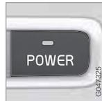
Diese Wahl sorgt dafür, dass das Fahrzeug bestes Ansprech- und Leistungsverhalten zeigt, da sowohl der elektrische als auch der Dieselmotor im Dauerbetrieb sind. Das Fahrzeug fährt sich
