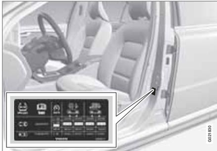
Auf dem Informationsschild für den Reifendruck an der Türsäule auf der Fahrerseite (zwischen Vorder- und Hintertür) ist der Reifendruck für die für das Fahrzeug empfohlenen Reifendimensionen aufgeführt. Der Reifendruck ist ebenfalls der Reifendrucktabelle zu entnehmen, siehe Seite 419.
