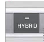
Diese Option ist der voreingestellte Antriebsmodus für den Start. Das Steuersystem verwendet sowohl den elektrischen als auch den mit Diesel betriebenen Motor - einzeln oder zusammen - und
