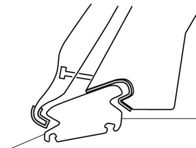
La figura muestra la colocación correcta de la fijación y el revestimiento de goma alrededor de la moldura.
