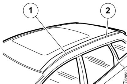
— Placer les barres transversales sur le toit de la voiture, aux points 1 et 2.
