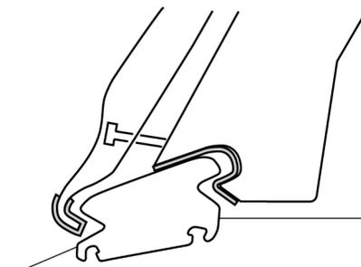
La figure montre le positionnement correct de la fixation et de la cale en caoutchouc autour du rail longitudinal.
