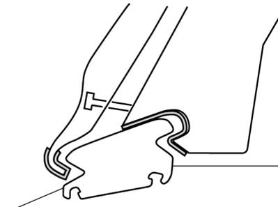
Die Abbildung zeigt die korrekte Position von Halter und Gummizwischenstück an der Dachleiste.
