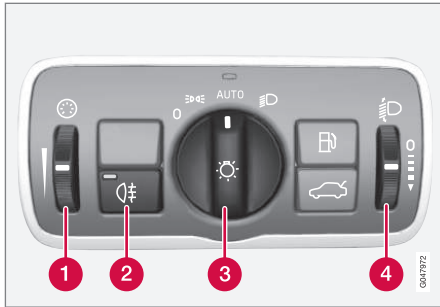
Übersicht Schalterfeld Beleuchtung.
