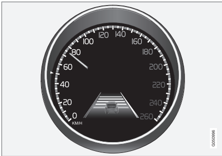
Seitenstreifen der LDW-Funktion.
