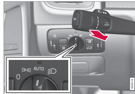
Lenkradhebel und Lichtschalter-Drehregler in Stellung AUTO .
