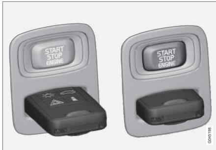
Zündschloss mit herausgezogenem/ingedrücktem Transponderschlüssel.
