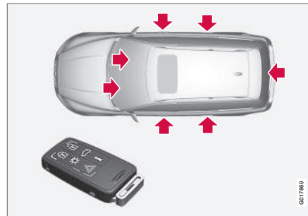
Verriegelungspunkte für Transponderschlüssel mit Schlüsselblatt.
