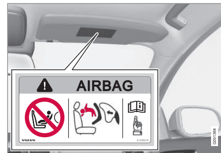
Möglichkeit 1: Airbagaufkleber an der Sonnenblende auf Beifahrerseite.
