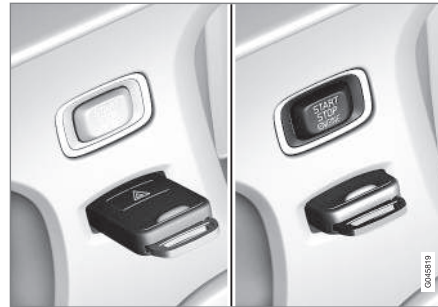
Zündschloss mit herausgezogenem/eingedrücktem Transponderschlüssel.
