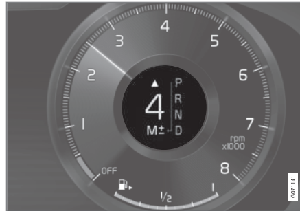
Schaltanzeige auf dem 12-Zoll-Fahrerdisplay bei großem Wählhebel*.
