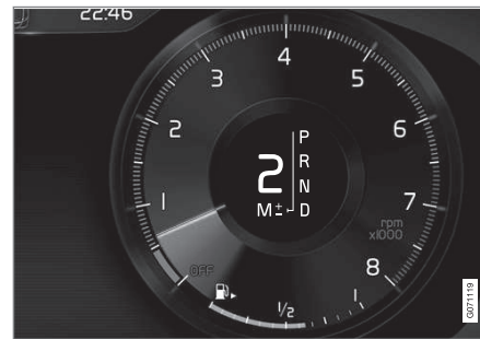
Schaltmuster auf dem Fahrerdisplay bei großem Wählhebel.
