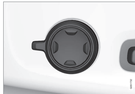
Multifunktionsschalter, in Fahrzeugen mit Vier-Wege-Lendenwirbelstütze*.
