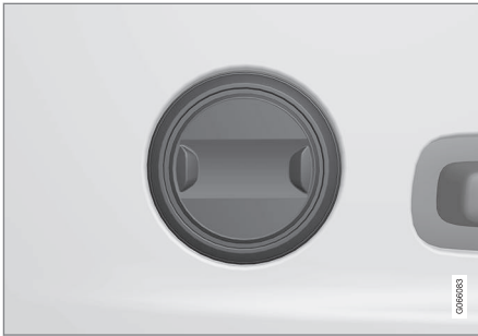
Bedienelement in Fahrzeugen mit Zwei-Wege-Lendenwirbelstütze*.
