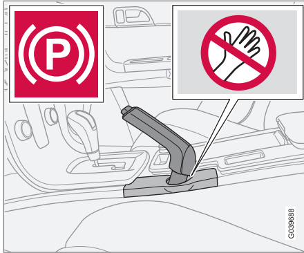
Warnsymbol im Armaturenbrett und Warnschild zur Klemmgefahr.
