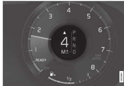
Schaltanzeige auf dem 12-Zoll-Fahrerdisplay*.
