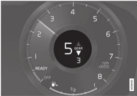
Schaltanzeige auf dem 12-Zoll-Fahrerdisplay*.
