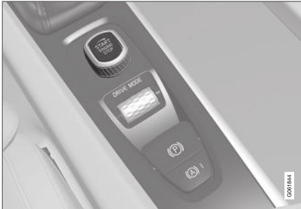
Startschalter auf der Tunnelkonsole.
