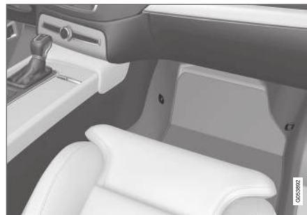
Lage der Befestigungspunkte für den Vordersitz
