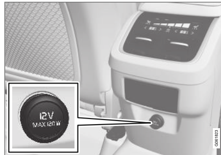
12-V-Steckdose in der Tunnelkonsole, Rücksitz.
