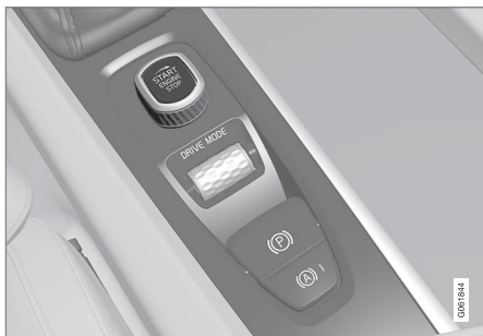
Startschalter auf der Tunnelkonsole.
