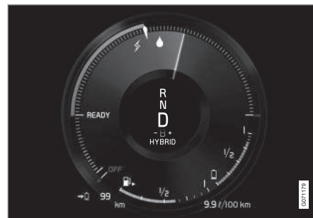
Fahrerdisplay bei Antrieb durch Elektro- und Verbrennungsmotor.
