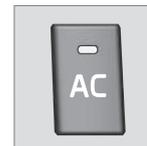
Wenn die Lampe in der **AC**-Taste leuchtet, wird die Klimaanlage automatisch durch das System gesteuert.
