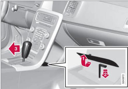
Wenn das Fahrzeug nicht gefahren werden kann, z. B. wenn die Batterie entladen ist, muss der Wählhebel aus der **P**-Stellung bewegt werden, damit das Fahrzeug bewegt werden kann.
