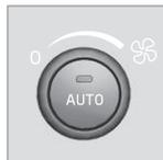
Mit dem Drehregler wird die Gebläsegeschwindigkeit erhöht oder gesenkt. Bei der Wahl von **AUTO** wird die Gebläsegeschwindigkeit automatisch (S. 134) geregelt - die zuvor eingestellte Gebläsegeschwindigkeit wird außer Acht gelassen.
