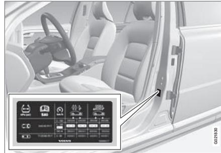
Auf dem Reifendruckaufkleber an der Türsäulinnenseite auf der Fahrerseite (zwischen Vorder- und Fondtür) ist der bei unterschiedlicher Beladung und unterschiedlichen Geschwindigkeitsverhältnissen geltende Reifendruck angegeben. Der Reifendruck ist außerdem in der Reifendrucktafel angegeben, siehe Reifen - zugelassener Reifendruck (S. 439).
