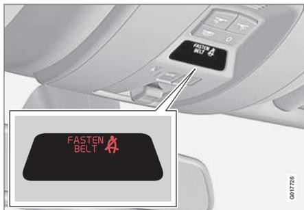
Das akustische Signal ist geschwindigkeitsabhängig und in bestimmten Fällen zeitabhängig. Das optische Signal befindet sich in der Dachkonsole und im Kombinationsinstrument (S. 64).
