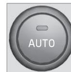
Bei Auswahl von einer oder mehreren manuellen Funktionen werden die übrigen Funktionen weiterhin automatisch gesteuert. Durch Drücken auf **AUTO** werden sämtliche manuellen Einstellungen ausge-
