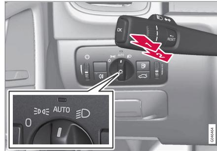
Lenkradhebel und Lichtschalter-Drehregler.
