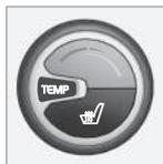
Mit dem Drehregler kann die Temperatur eingestellt werden - getrennt für die Fahrer- und Beifahrerseite.
