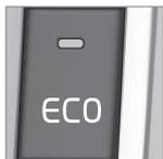
Bei aktivierter ECO-Funktion kann der Motor bereits vor dem Stillstand des Fahrzeugs abgeschaltet werden.
