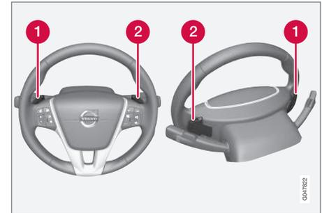
Die beiden "Schaltwippen" des Lenkrads.
