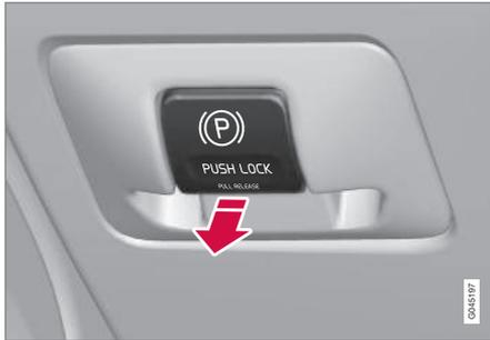
Feststellbremsregler - lösen.
