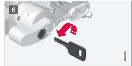
6 Den Schlüssel gegen den Uhrzeigersinn in die verriegelte Stellung drehen. Den Schlüssel aus dem Schloss abziehen.
