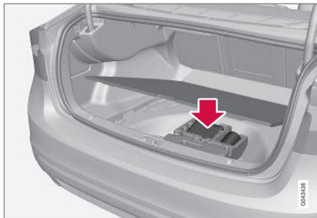
Unter dem Laderraumboden sind die Abschleppöse, der Wagenheber\* und der Radschraubenschlüssel\* des Fahrzeugs verstaut. Hier gibt es auch Platz für die Hülse der abschließbaren Radschrauben sowie Werkzeug für die Kunststoffkappen der Radschrauben.
