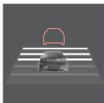
Es können verschiedene Zeitabstände zum vorausfahrenden Fahrzeug eingestellt und im Kombinationsinstrument als 1–5 horizontale Linien angezeigt werden – je mehr Linien, desto größer der Zeitabstand.
