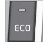
Ist die ECO-Funktion deaktiviert, erlöschen das ECO-Symbol auf dem Kombinationsinstrument und die Beleuchtung der ECO -Taste. Damit ist die Funktion deaktiviert, bis sie durch erneutes Drücken der ECO -Taste wieder aktiviert wird.
