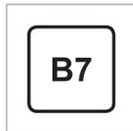
B7 ist **Dieselmotorkraftstoff** mit max. 7 Vol.-% Fettsäuremethylester (FAME).
