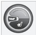
Die Taste mehrmals drücken, um zwischen den verfügbaren Modi zu wechseln oder die Funktion abzuschalten.
