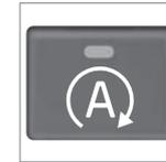
Die Start/Stop-Funktion wird automatisch aktiviert, wenn der Motor mit dem Schlüssel gestartet wird. Der Fahrer wird darauf aufmerksam gemacht, indem das Symbol der Funktion im Kombinationsinstrument aufleuchtet und die Lampe in der Ein-/Aus-Taste leuchtet.
