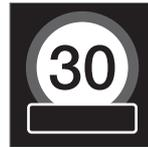
Bei Anzeige eines leeren Rahmens unter dem Geschwindigkeitssymbol im Kombinationsinstrument<sup>26</sup> hat das RSI ein Zusatzschild mit zusätzlichen Informationen zur aktuellen Geschwindigkeitsbegrenzung
