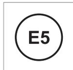
E5 ist Benzin, das max. 2,7 % Sauerstoff und max. 5 Vol.-% Ethanol enthält.
