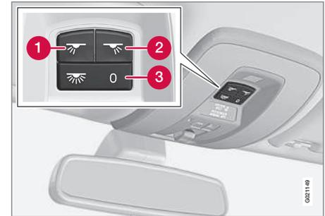
Schalter in der Dachkonsole für vordere Leseleuchten und Innenbeleuchtung.
