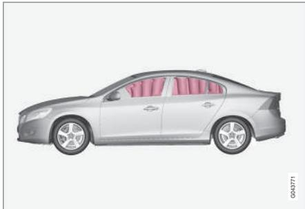
Der Kopf-/Schulterairbag (Inflatable Curtain) ist ein Teil des SIPS-Systems (S. 38) und des Airbagsystems (S. 33). Sie sind an beiden Außenseiten des Dachhimmels angebracht, und helfen dabei, Fahrer und Beifahrer, sowie die Mitreisenden auf den äußeren Rücksitzen zu schützen. Bei einem ausreichend starken Aufprall reagieren die Sensoren und der Kopf-/Schulterairbag wird aufgeblasen.
