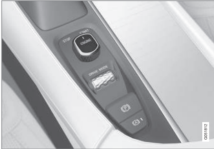
Startschalter auf der Tunnelkonsole.
