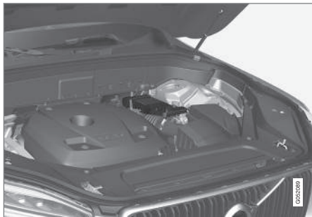
Die Unterstützungsbatterie befindet sich in einem Gehäuse neben dem Federbeinturm.
