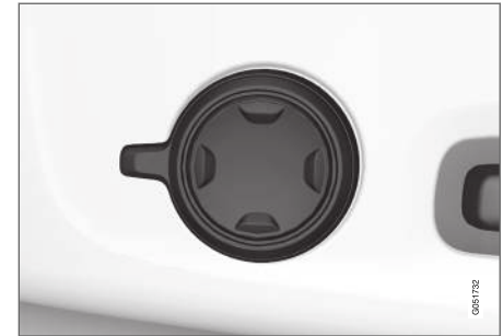
Seitlich am Sitzpolster angebrachter Multifunktionsschalter.
