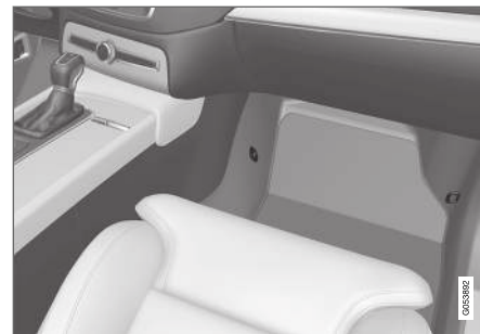
Lage der Befestigungspunkte für den Vordersitz
