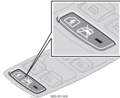
*Elektrische Verriegelung zum Öffnen der Hintertür und des Seitenfensters*
