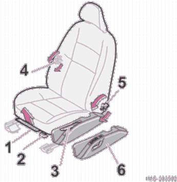
4. Die Lendenwirbelstütze ändern, den Knopf drehen
