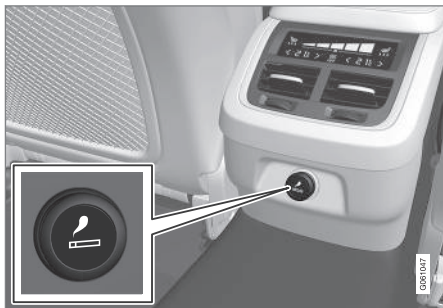
Zigarettenanzünder in der Tunnelkonsole, Rücksitz.
