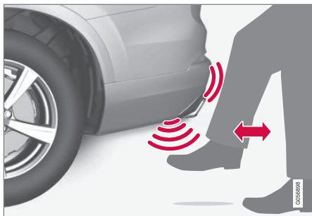
Trittbewegung innerhalb des gültigen Aktivierungsbereichs des Sensors.
