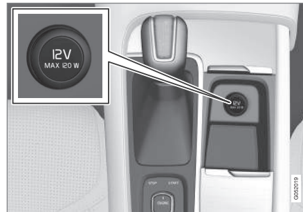
12-V-Steckdose in der Tunnelkonsole, vorn.
