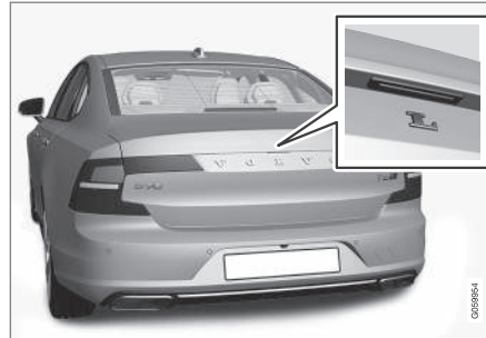
Gummiplatte mit druckempfindlicher Oberfläche.
