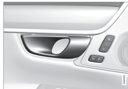
Griff zum alternativen Entriegeln der Vordertür.
