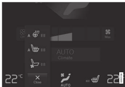
Lenkrad- und Sitztasten in der Klimaleiste.
