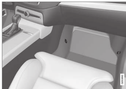
Lage der Befestigungspunkte für den Vordersitz
