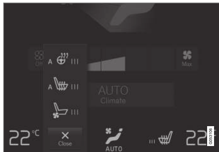
Lenkrad- und Sitztasten in der Klimaleiste.
