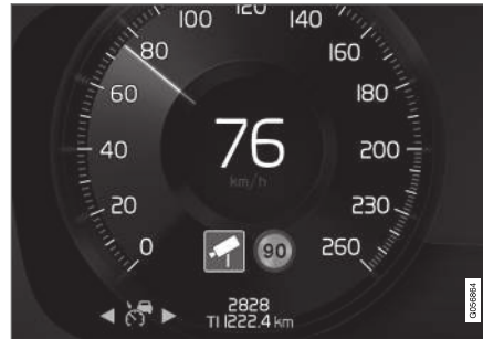
Radarkamerawarnung auf dem Fahrerdisplay 110 .
