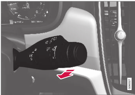
Waschfunktion, rechter Lenkradhebel.
