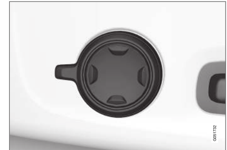
Seitlich am Sitzpolster angebrachter Multifunktionsschalter.
