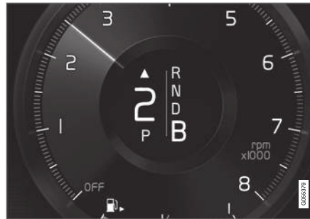
Schaltanzeige im Fahrerdisplay 3 .
