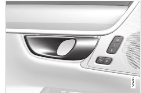
Griff zum alternativen Entriegeln der Tür 15 .
