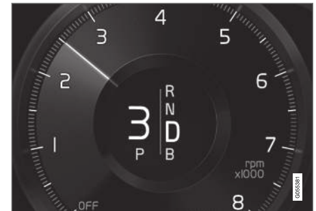
Fahrerdisplay beim Schalten mit den Schaltwippen.
