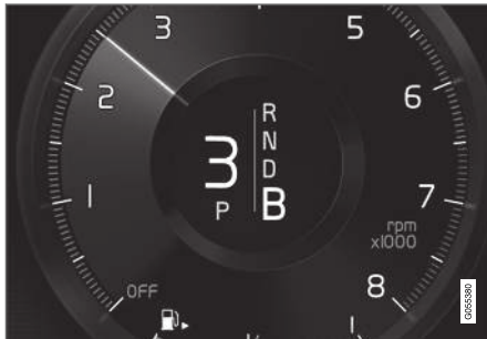
Schaltstellung B auf dem Fahrerdisplay.
