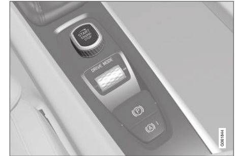
Startschalter auf der Tunnelkonsole.
