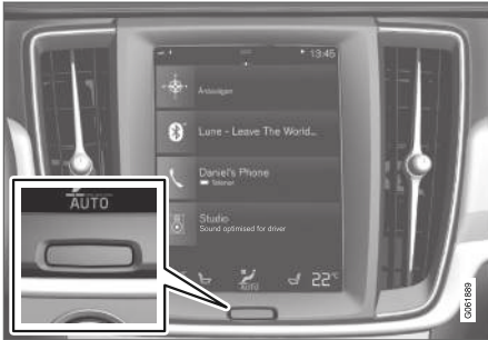
Home-Taste des Displays in der Mittelkonsole.
