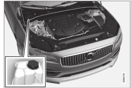
Ausgleichsbehälter der Kühlanlage, Linkslenker.
