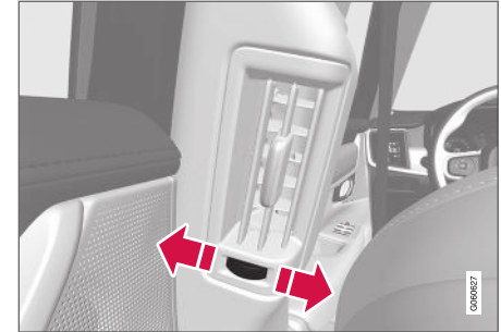
Stellrad der Belüftungsdüse 2 .
