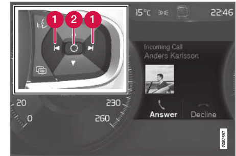
Meldung auf dem Fahrerdisplay und rechtes Lenkradtastenfeld.
