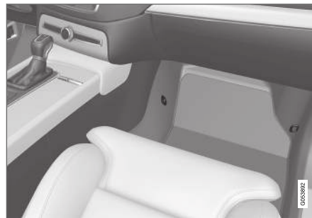
Lage der Befestigungspunkte für den Vordersitz
