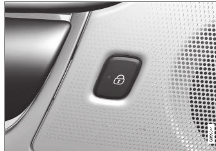
Verriegelungstaste mit Anzeigeleuchte an der Hintertür.
