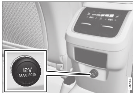
12-V-Steckdose in der Tunnelkonsole, Rücksitz.
