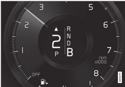
Schaltanzeige im Fahrerdisplay 2 .
