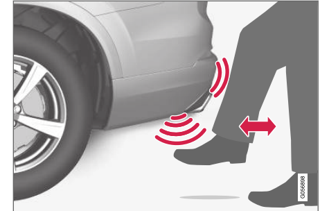
Trittbewegung innerhalb des gültigen Aktivierungsbereichs des Sensors.
