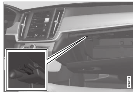
Ablagefach für den Schlüssel. Die Abbildung ist schematisch - die Gestaltung kann variieren.
