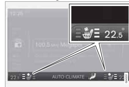
Die aktuelle Komfortstufe wird am Bildschirm der Mittelkonsole angezeigt.
