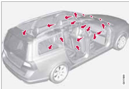
Die einströmende Luft wird über eine Reihe verschiedener Belüftungsdüsen im Fahrzeuginnenraum verteilt.
