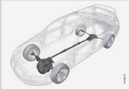
Fahrzeuge mit Allradantrieb werden von allen vier Rädern gleichzeitig angetrieben.
