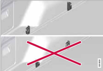
*Die Ladungssicherungshaken korrekt montieren!*
