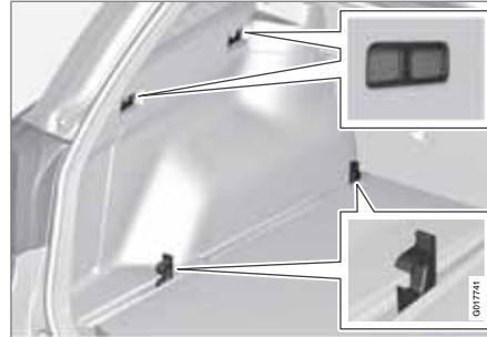
Auf beiden Seiten des Laderaums befinden sich mehrere Befestigungspunkte zur Verankerung von Ladegut. Die Befestigungspunkte sind am Boden und an der Oberkante der Kofferraumwände angeordnet.
