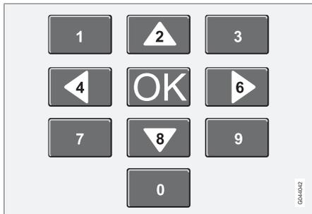
Die Navigation im eigenen Menü der DVD-Video-Disc erfolgt über die Zahlentasten in der Mittelkonsole gemäß der Abbildung oben.
