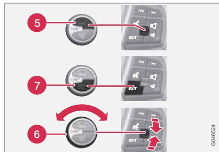
Tastenfeld am Lenkrad, das als Alternative zu den Bedienelementen in der Mittelkonsole dient.
