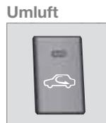
Wenn die Umluftfunktion eingeschaltet ist, leuchtet die orangefarbene Lampe in der Taste. Die Funktion wird gewählt, um zu verhindern, dass schlechte Luft, Abgase usw. in den Fahrzeuginnenraum gelangen. Die Luft im Fahrzeuginnenraum wird umgewälzt, d. h. bei aktivierter Funktion wird keine Außenluft in das Fahrzeug eingesaugt.
