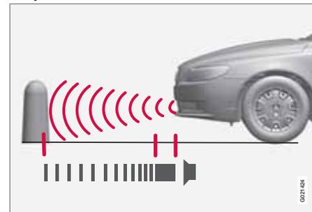
Der Messbereich in gerader Richtung vor dem Fahrzeug liegt bei ca. 0,8 m. Das Tonsignal für Hindernisse vor dem Fahrzeug kommt aus einem der vorderen Lautsprecher.
