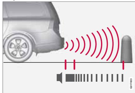
Der Messbereich in gerader Richtung hinter dem Fahrzeug liegt bei ca. 1,5 m. Das Tonsignal für Hindernisse hinter dem Fahrzeug kommt aus einem der hinteren Lautsprecher.
