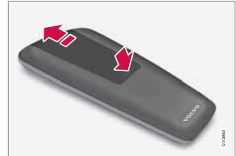
1. Die Verriegelung am Batteriedeckel herunterdrücken und den Batteriedeckel in Richtung IR-Linse schieben.
