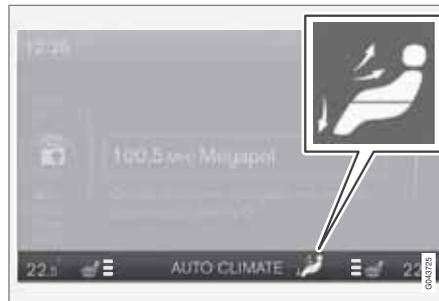
Die gewählte Luftverteilung wird am Bildschirm der Mittelkonsole angezeigt.
