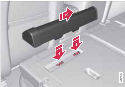
Die zweigeteilte Schutznetz-kassette wird auf der Rückseite der Rückenlehne befestigt. Die schmalere Kassette wird auf der linken Seite (von der Heckklappe aus gesehen) befestigt.
