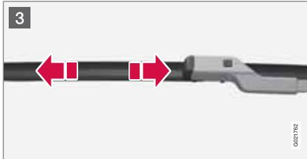
1. Den Wischerarm hochklappen, wenn er sich in Wartungsstellung befindet. Auf die Taste an der Wischerblattbefestigung drücken und das Wischerblatt gerade – parallel zum Wischerarm – herausziehen.
