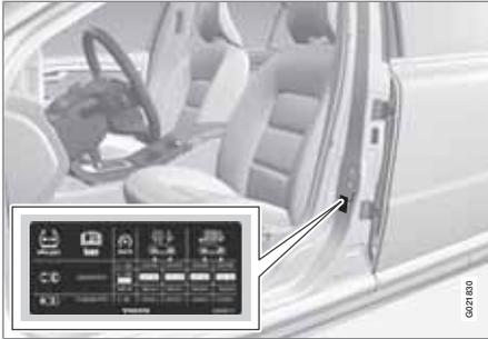
Auf dem Reifendruckaufkleber an der Türsäuleninnenseite auf der Fahrerseite (zwischen Vorder- und Fondtür) ist der bei unterschiedlicher Beladung und unterschiedlichen Geschwindigkeitsverhältnissen geltende Reifendruck angegeben. Der Reifendruck ist ebenfalls der Reifendrucktabelle zu entnehmen, siehe Seite 426.
