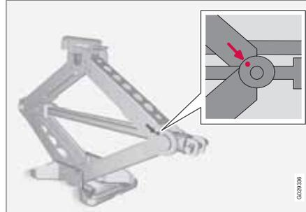
Nach der Benutzung von Werkzeug und Wagenheber\* müssen diese wieder korrekt verstaut werden. Der Wagenheber wird in die korrekte Stellung zusammengeklappt, damit er passt.
