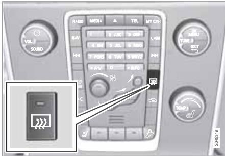
Diese Funktion verwenden, um schnell Eis und Beschlag an der Heckscheibe und den Außenspiegeln zu entfernen.
