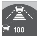
Es können verschiedene Zeitabstände zum vorausfahrenden Fahrzeug eingestellt und im Display als 1–5 horizontale Linien angezeigt werden – je mehr Linien, desto größer der Zeitabstand. Eine Linie entspricht ca. 1 Sekunde zum vorausfahrenden Fahrzeug, 5 Linien ca. 3 Sekunden.
