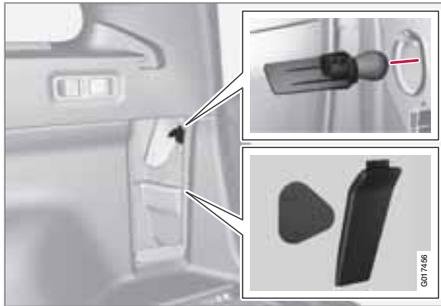
Die Blinkerlampe in der Heckleuchte wird vom Laderaum aus gewechselt.
