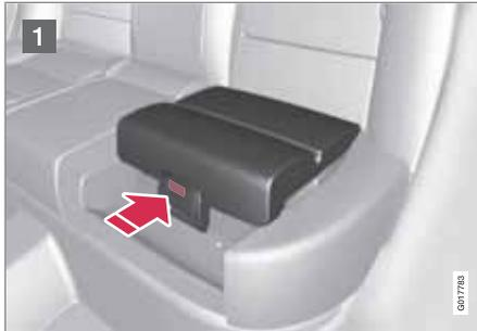
1 Ausgangsstellung: Untere Stufe. Auf die Taste drücken.
