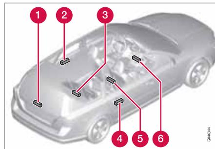
Die Antennen des Keyless-Systems sind an verschiedenen Stellen des Fahrzeugs eingebaut:
