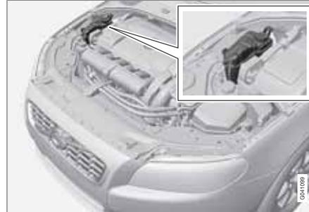
Beim Einfüllen sind die Anweisungen auf der Verpackung zu befolgen. Es ist wichtig, die Kühlmittel-/Wassermenge an die herrschenden Witterungsbedingungen anzupassen. Niemals nur Wasser nachfüllen. Die Gefriergefahr erhöht sich bei zu niedrigem bzw. zu hohem Kühlmittelanteil.
