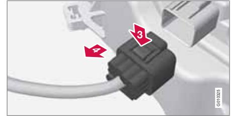
Zum Austauschen der Scheinwerferglühlampen den Scheinwerfer vom Motorraum aus lösen und den kompletten Scheinwerfer herausnehmen.
