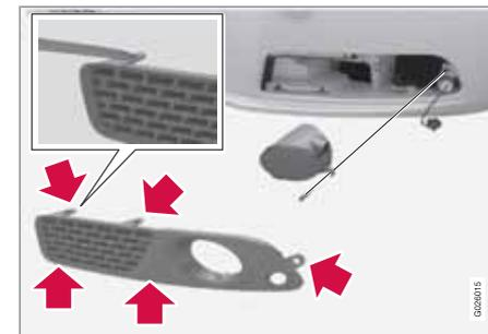
1. Die Abdeckung entfernen. Dazu die 4 Clips mit einem dünnen Blatt eindrücken und die Abdeckung gerade herausziehen.
