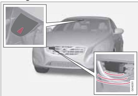
Kamera- und Radarsensor<sup>4</sup>.
