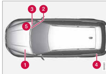
Position der Zentralelektriken Linkslenker, bei Rechtslenkern wechseln die Zentralelektriken unter dem Handschuhfach die Seite.
