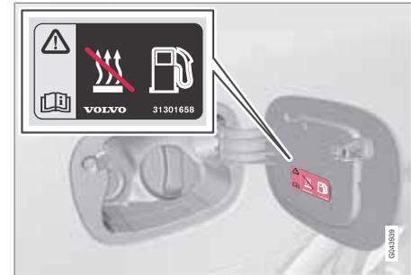
Bei hohen Außentemperaturen kann ein Überdruck im Tank entstehen. Den Verschluss in diesem Fall langsam öffnen.
