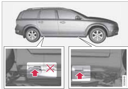
Wenn das Fahrzeug mit einem Werkstattwagenheber aufgebockt wird, muss dieser an der Vorderkante des Motorhilfsrahmens angesetzt werden.
