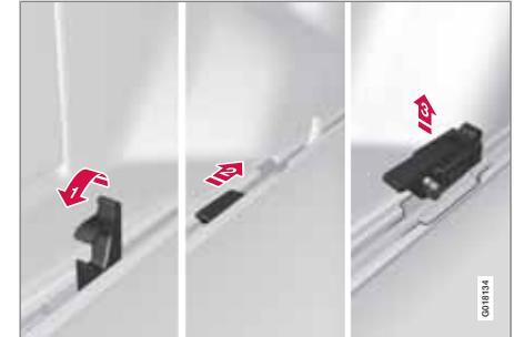
Die Ladungssicherungshaken lassen sich einfach aus der Schiene entfernen, z. B. bei der Reinigung des Schienenbodens.
