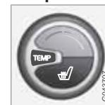
Mit dem Drehregler kann die Temperatur eingestellt werden. Bei ECC\* kann die Temperatur auf der Fahrer- und auf der Beifahrerseite separat eingestellt werden.
