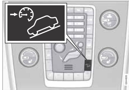
HDC wird mit einem Schalter auf der Mittelkonsole ein- bzw. ausgeschaltet. Eine Lampe in der Taste leuchtet, wenn die Funktion eingeschaltet ist. Wenn HDC arbeitet, leuchtet das Symbol und im Display wird **Hill descent control EIN** angezeigt.
