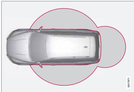
Mit der „Keyless Drive“-Funktion des PCC kann das Fahrzeug ohne Schlüssel entriegelt, gefahren und verriegelt werden. Dazu reicht es aus, den PCC bei sich zu haben. Das System ermöglicht ein bequemerer Öffnen des Fahrzeugs, wenn Sie z. B. keine Hand frei haben.
