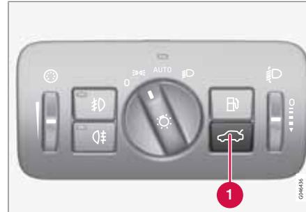
Zum Entriegeln der Heckklappe:
