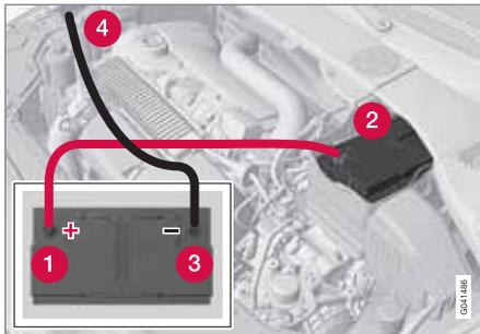
Wenn die Startbatterie entladen ist, kann der Motor mit dem Strom einer anderen Batterie angelassen werden.
