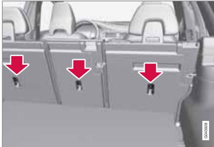
Das Fahrzeug ist mit oberen Befestigungspunkten für bestimmte vorwärts gerichtete Kindersitze ausgerüstet. Die Befestigungspunkte befinden sich auf der Rückseite des Sitzes.
