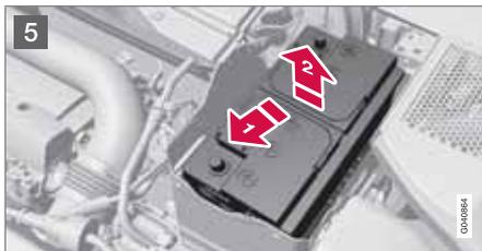
1 Die Clips an der vorderen Abdeckung öffnen und die Abdeckung abnehmen.
