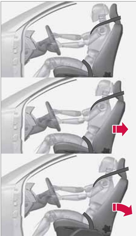
Das WHIPS-System (Whiplash Protection System) besteht aus Energie aufnehmenden Rückenlehnen und speziell für das System entwickelten Kopfstützen an den Vordersitzen. Das System wird bei einem Heckaufprall aktiviert, wobei Aufprallwinkel, Geschwindigkeit und Eigenschaften des auffahrenden Fahrzeugs ausschlaggebend sind.
