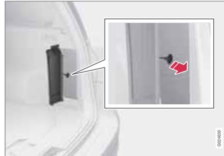
Die Kraftstofftankklappe kann von Hand geöffnet werden, wenn das elektrische Öffnen vom Fahrzeuginnenraum nicht möglich ist.
