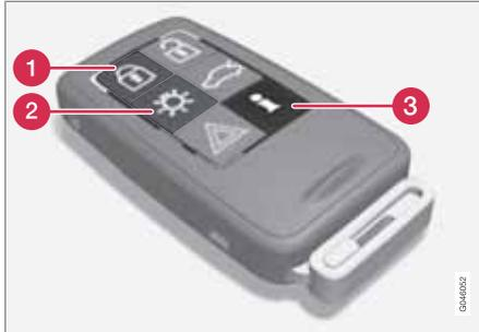
Die Tasten des Transponderschlüssels für den Fernstart.
