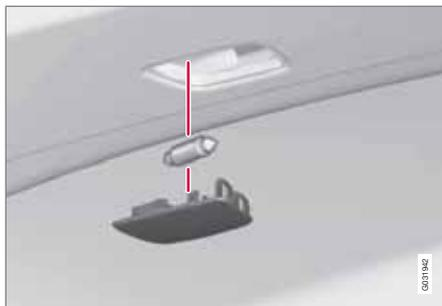
1. Vorsichtig einen Schraubendreher in das Lampengehäuse einführen und vorsichtig loshebeln, um das Lampengehäuse zu lösen.
