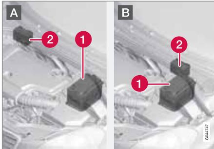
A: Linkslenker. B: Rechtslenker. 1. Startbatterie<sup>3</sup> 2. Unterstützungsbatterie.
