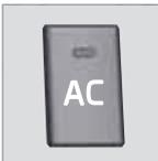
Wenn die Lampe in der **AC**-Taste leuchtet, wird die Klimaanlage automatisch durch das System gesteuert. Auf diese Weise wird die einströmende Luft gekühlt und entfeuchtet.
