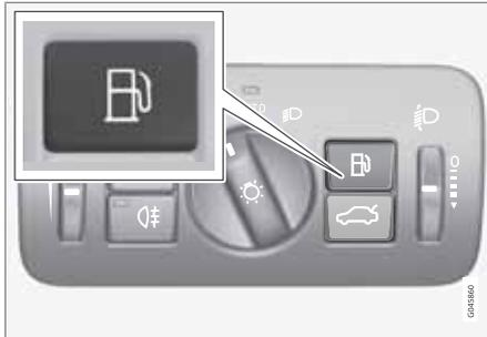
Die Kraftstofftankklappe mit der Taste am Schalterfeld Beleuchtung öffnen – die Klappe öffnet sich, sobald die Taste losgelassen wird.
