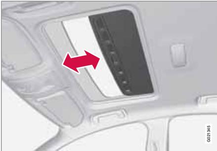
Mit einem langen Druck auf die Verriegelungstaste werden das Schiebedach und sämtliche Fenster geschlossen, siehe Seiten 50 und 61. Die Türen und die Heckklappe werden verriegelt. Wenn der Schließvorgang unterbrochen werden muss, erneut auf die Verriegelungstaste drücken.
