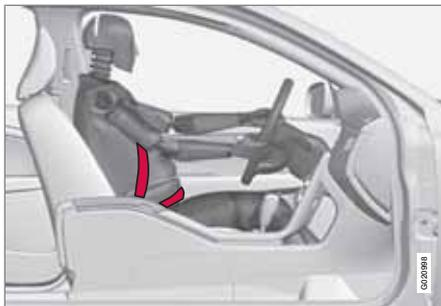
Während der Schwangerschaft muss der Sicherheitsgurt immer angelegt werden. Dabei ist es von äußerster Wichtigkeit, dass er korrekt angelegt wird. Der Sicherheitsgurt muss dicht an der Schulter anliegen, der Diagonalteil des Sicherheitsgurtes muss zwischen den Brüsten zur Seite des Bauches geführt werden.
