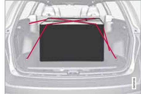
An oberen und unteren Befestigungspunkten gesicherte Ladung.
