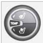
Die Vordersitzlüftung kann nur gewählt werden, wenn ECC im Fahrzeug installiert ist. Die Lüftungsanlage besteht aus Gebläsen in Sitzen und Rückenlehnen, die Luft durch den Sitzbezug saugen.
