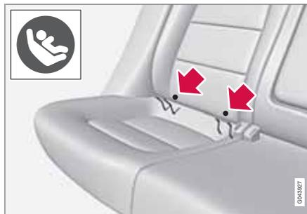
Die Befestigungspunkte für das ISOFIX-Befestigungssystem sind hinter dem unteren Teil der
