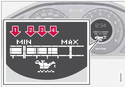
Die Zahlen 1–4 stehen für den Füllstand. Kein Öl mehr einfüllen, wenn der Füllstand (3) oder (4) angezeigt wird. Empfohlen wird der Füllstand 4.
