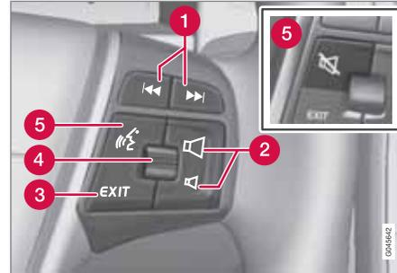
**1** Mit einem **kurzen Druck** wird zwischen den einzelnen Titeln oder den gespeicherten Radiosendern geblättert<sup>4</sup>. **Durch langes Drücken** wird der Titel schnell gespult
