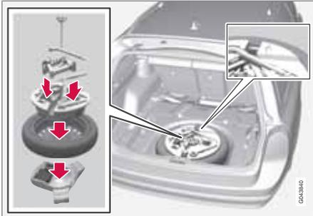
Unter dem Laderaumboden sind die Abschleppöse, der Wagenheber\* und der Radschraubenschlüssel\* des Fahrzeugs verstaut. Hier gibt es auch Platz für die Hülse der abschließbaren Radschrauben.
