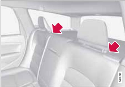
Zugschlaufen zum Hochziehen des Netzes.
