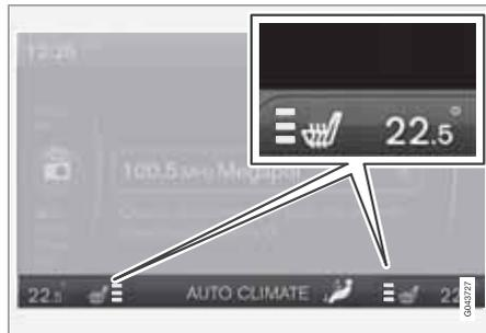
Die aktuelle Heizleistung wird am Bildschirm der Mittelkonsole angezeigt.
