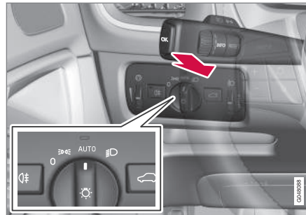
Lenkradhebel und Lichtschalter-Drehregler in Stellung AUTO .
