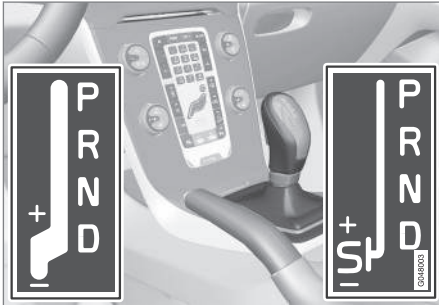
D: Automatische Gangstellungen. +/-: Manuelle Gangstellungen. S: Sportmodus. 12
