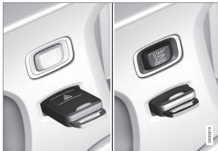
Zündschloss mit herausgezogenem/ingedrücktem Transponderschlüssel.
