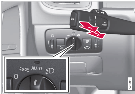
Lenkradhebel und Lichtschalter-Drehregler.
