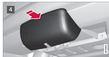
4 Die Schutzkappe aufschieben, bis sie festschnappt.
