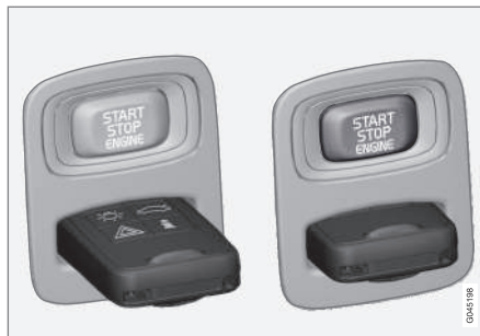
Zündschloss mit herausgezogenem/eingedrücktem Transponderschlüssel.
