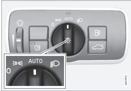
Drehregler des Lichtschalters in Stellung AUTO .
