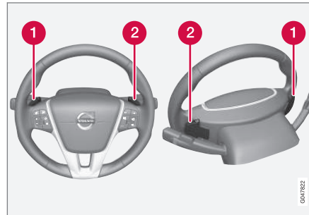
Die beiden "Schaltwippen" des Lenkrads.
