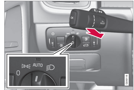
Lenkradhebel und Lichtschalter-Drehregler in Stellung AUTO .
