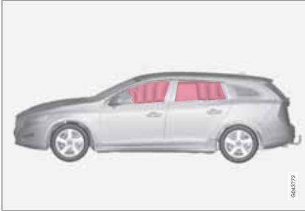
Der Kopf-/Schulterairbag IC (Inflatable Curtain) ist ein Teil von SIPS und Airbags. Der Kopf-/Schulterairbag ist im Dachhimmel entlang den Seiten des Fahrzeugs verborgen. Er schützt die Insassen auf den Außenplätzen des Fahrzeugs. Bei einem ausreichend starken Aufprall reagieren die Sensoren und der Kopf-/Schulterairbag wird aufgeblasen. Der Kopf-/Schulterairbag verhindert, dass der Kopf von Fahrer oder Beifahrer im Falle eines Aufpralls gegen die Innenseite des Fahrzeugs stößt.
