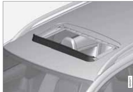
Zum Schiebedach gehört ein Windabweiser, der bei geöffnetem Schiebedach hochgeklappt wird.
