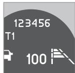
Die Anzahl der Linien des gewählten Zeitabstands wird während der Einstellung selbst und einige Sekunden danach angezeigt, anschließend erscheint das Symbol in verkleinerter Form rechts im
