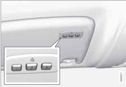
HomeLink®<sup>1</sup> ist eine programmierbare Fernbedienung, mit denen bis zu drei verschiedene Systeme (z. B. Garagentorentriegelung, Alarmanlage, Außen- und Innenbeleuchtung u. v. a. m.) ferngesteuert werden können und die somit die Fernbedienungen dieser Systeme ersetzen kann. Weitere Informationen zu HomeLink® bekommen Sie unter: [www.homelink.com](http://www.homelink.com) oder telefonisch unter 00 8000 466 354 65 (oder der kostenpflichtigen Telefonnummer +49 6838 907 277).
