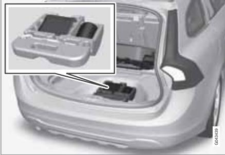
Die provisorische Reifenabdichtung (TMK, Temporary Mobility Kit) wird zur Abdichtung eines beschädigten Reifens sowie zur Kontrolle und Einstellung des Reifendrucks verwendet. Er besteht aus einem Kompressor und einem Behälter mit Abdichtmasse. Der Satz dient zur provisorischen Reparatur. Die Flasche mit Abdichtmasse ist vor Ablauf des Haltbarkeitsdatums und nach dem Gebrauch auszutauschen.
