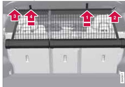
Das Netz wird aus den Kasnetten herausgezogen und arretiert automatisch nach etwa einer Minute, wenn die Rückenlehnen der Rücksitzbank hochgeklappt sind.
