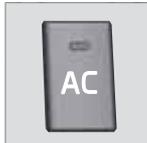
Wenn die Lampe in der AC-Taste leuchtet, wird die Klimaanlage automatisch durch das System gesteuert. Auf diese Weise wird die einströmende Luft gekühlt und entfeuchtet.
