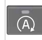
In bestimmten Situationen ist es wünschenswert, die automatische Start/Stop-Funktion vorübergehend ausschalten zu können – dies erfolgt durch Drücken auf diese Taste, wodurch die Taste erlischt.
