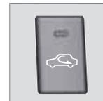
Wenn die Umluftfunktion eingeschaltet ist, leuchtet die orangefarbene Lampe in der Taste. Die Funktion wird gewählt, um zu verhindern, dass schlechte Luft, Abgase usw. in den Fahrzeuginnenraum gelangen.
