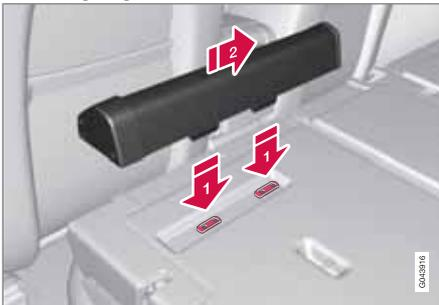
Die zweigeteilte Schutznetzkasnetten wird auf der Rückseite der Rückenlehne befestigt. Die schmalere Kasnetten wird auf der linken Seite (von der Heckklappe aus gesehen) befestigt.
