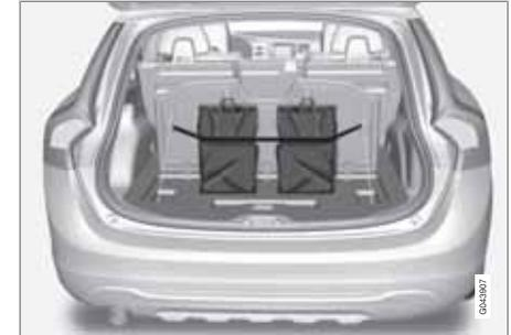
Tragetaschenhalter unter aufklappbarer Klappe im Boden.
