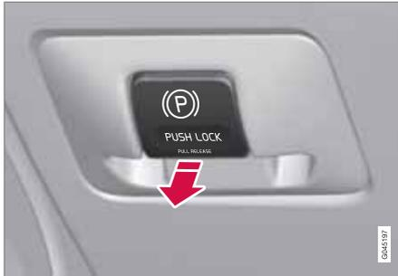
Feststellbremsregler - lösen.
