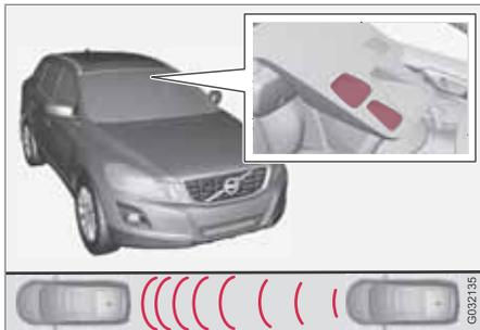
Sender- und Empfängerfenster des Lasersensors<sup>1</sup>.
