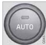
Die Autofunktion regelt automatisch Temperatur, Klimaanlage, Gebläsegeschwindigkeit, Umlufffunktion und Luftverteilung.
