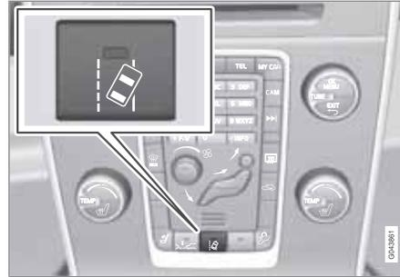
Die Funktion wird mit einem Schalter an der Mittelkonsole ein- bzw. ausgeschaltet. Eine Lampe in der Taste leuchtet, wenn die Funktion eingeschaltet ist.
