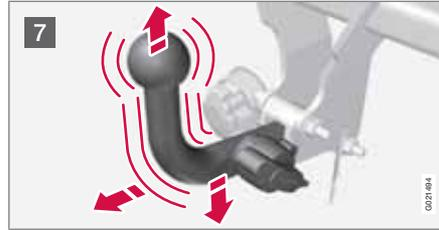
7 Sicherstellen, dass die Anhängerzugvorrichtung fest sitzt: Diese dazu hoch-, herunter- und zurückbewegen.
