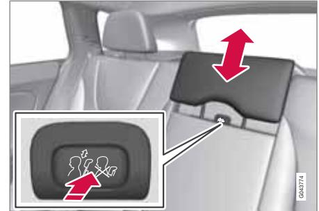
Die Kopfstütze an die Körpergröße des Insassen anpassen, so dass sie möglichst den ganzen Hinterkopf abdeckt. Die Kopfstütze je nach Wunsch nach oben schieben.
