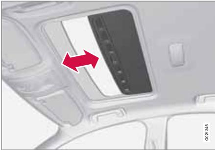
Mit einem langen Druck auf die Verriegelungstaste werden das Schiebedach und sämtliche Fenster geschlossen, siehe Seiten 50 und 64. Die Türen und die Heckklappe werden verriegelt. Wenn der Schließvorgang unterbrochen werden muss, erneut auf die Verriegelungstaste drücken.
