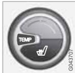
Mit dem Drehregler kann die Temperatur eingestellt werden. Bei ECC\* kann die Temperatur auf der Fahrer- und auf der Beifahrerseite separat eingestellt werden.
