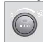
Mit dem Drehregler wird die Gebläsegeschwindigkeit erhöht oder gesenkt. Die Gebläsegeschwindigkeit wird automatisch geregelt, wenn **AUTO** gewählt wird. Die zuvor eingestellte Gebläsegeschwindigkeit wird deaktiviert.
