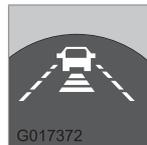
Es können verschiedene Zeitabstände zum vorausfahrenden Fahrzeug eingestellt und im Display als 1–5 horizontale Linien angezeigt werden – je mehr Linien, desto größer der Zeitabstand. Eine Linie entspricht ca. 1 Sekunde zum vorausfahrenden Fahrzeug, 5 Linien ca. 3 Sekunden.
