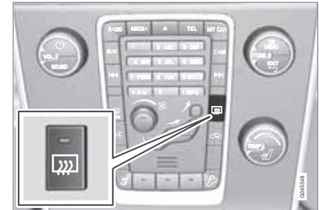
Diese Funktion verwenden, um schnell Eis und Beschlag an der Heckscheibe und den Außenspiegeln zu entfernen.
