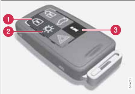
Die Tasten des Transponderschlüssels für den Fernstart.
