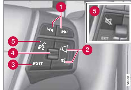
**1** Mit einem **kurzen Druck** wird zwischen den einzelnen Titeln oder den gespeicherten Radiosendern geblättert<sup>4</sup>. **Durch langes Drücken** wird der Titel schnell gespult
