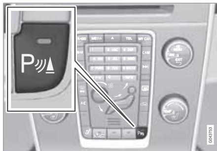
Das System wird automatisch beim Motorstart aktiviert – die Lampe des Schalters für Aus/Ein leuchtet. Wird die Einparkhilfe mit der Taste ausgeschaltet, erlischt die Lampe.
