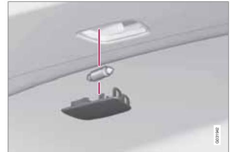
1. Vorsichtig einen Schraubendreher in das Lampengehäuse einführen und vorsichtig loshebeln, um das Lampengehäuse zu lösen.
