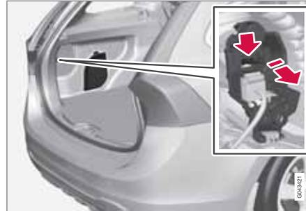
Die Rückfahrcheinwerferlampe, die Nebelschlussleuchtenlampe und die Blinkerlampe in der Heckleuchte werden vom Laderaum aus gewechselt.
