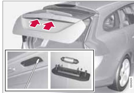
1. Die Schrauben mit einem Schraubendreher lösen.
