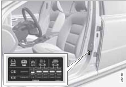
Auf dem Reifendruckaufkleber an der Türsäuleninnenseite auf der Fahrerseite (zwischen Vorder- und Fondtür) ist der bei unterschiedlicher Beladung und unterschiedlichen Geschwindigkeitsverhältnissen geltende Reifendruck angegeben. Der Reifendruck ist ebenfalls der Reifendrucktabelle zu entnehmen, siehe Seite 412.
