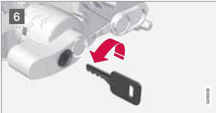
6 Den Schlüssel gegen den Uhrzeigersinn in die verriegelte Stellung drehen. Den Schlüssel aus dem Schloss abziehen.
