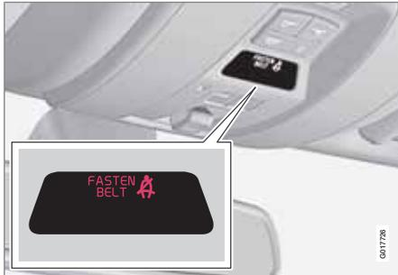
Insassen, die ihren Sicherheitsgurt nicht angelegt haben, werden durch ein akustisches und ein optisches Signal darauf aufmerksam gemacht, den Sicherheitsgurt anzulegen. Das akustische Signal ist geschwindigkeitsabhängig und in bestimmten Fällen zeitabhängig. Das optische Signal befindet sich in der Dachkonsole und im Kombinationsinstrument.
