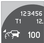
Wenn das Symbol nicht mehr , sondern anzeigt, hat der Radarsensor ein Fahrzeug erfasst.
