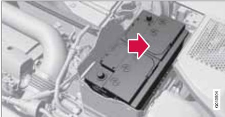
1. Die Batterie in den Batteriekasten stellen.
