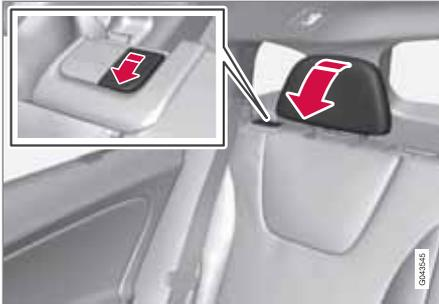
Am Sperrgriff, der sich am nächsten an der Kopfstütze befindet, ziehen, um die Kopfstütze vorzuklappen.
