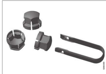
Ausbauwerkzeug für die Kunststoffkappen der Radmuttern.
