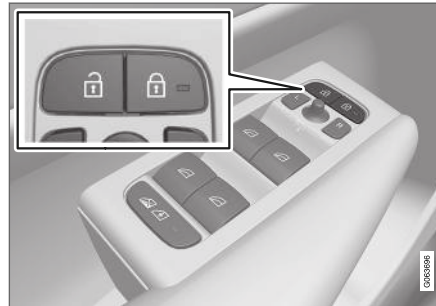
Ver- und Entriegelungstaste mit Anzeigeluchte an der Vordertür.
