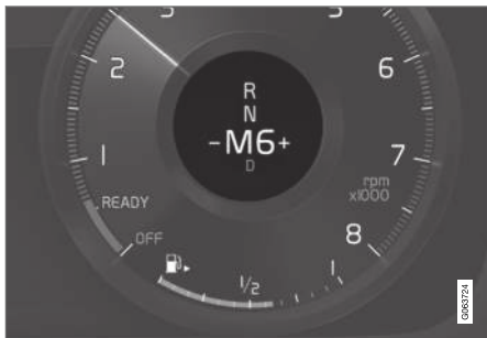
Manuelle Schaltstellung im Fahrerdisplay.
