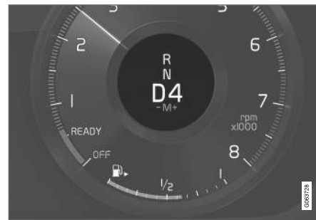
Fahrerdisplay beim Schalten mit den Schaltwippen.
