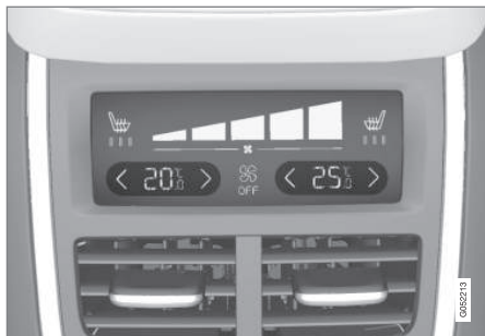
Temperaturregler auf dem hinteren Klima-Bedienfeld an der Tunnelkonsole.
