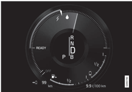
Fahrerdisplay bei Antrieb durch Elektro- und Verbrennungsmotor.
