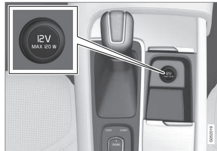
12-V-Steckdose in der Tunnelkonsole, vorn.
