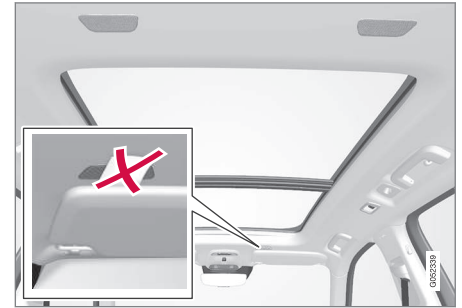
Mikrofone im Dachhimmel.
