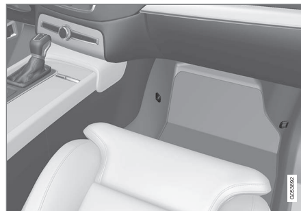
Lage der Befestigungspunkte für den Vordersitz
