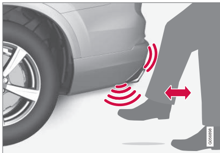
Trittbewegung innerhalb des gültigen Aktivierungsbereichs des Sensors.
