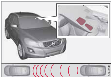
Sender- und Empfängerfenster des Lasersensors 1 .
