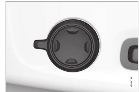
Seitlich am Sitzpolster angebrachter Multifunktionsschalter.
