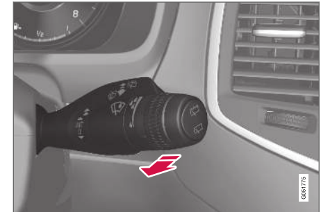
Waschfunktion, rechter Lenkradhebel.
