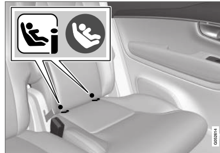
Lage der Befestigungspunkte in der zweiten Sitzreihe.
