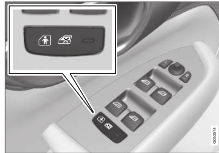
Taste zur elektrischen Aktivierung und Deaktivierung.
