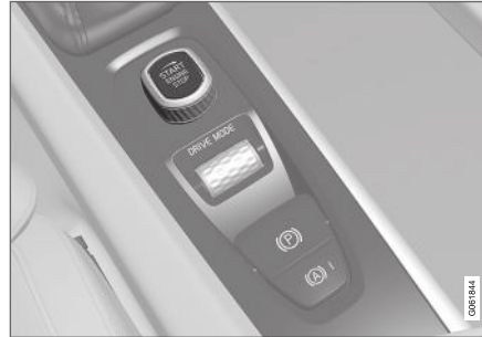
Startschalter auf der Tunnelkonsole.
