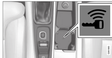
Lage des Schlüssellesegeräts in der Tunnelkonsole.
