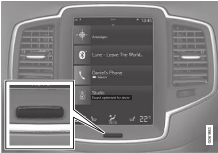
Home-Taste des Displays in der Mittelkonsole.
