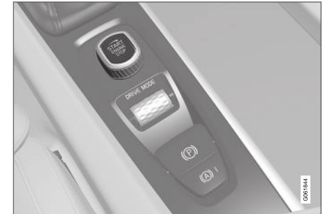
Startschalter auf der Tunnelkonsole.
