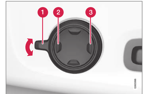
Multifunktionsschalter an der Seite des Sitzpolsters.
