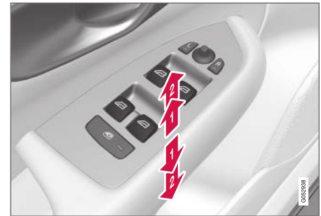
Betätigung der Fensterheber.
