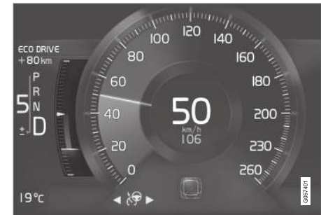
Eco-Anzeige auf dem 8-Zoll-Fahrerdisplay.
