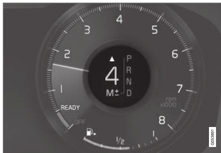
Schaltanzeige auf dem 12-Zoll-Fahrerdisplay*.
