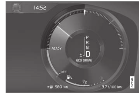
Eco-Anzeige auf dem 12-Zoll-Fahrerdisplay*.
