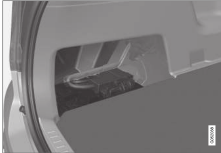
Die Startbatterie befindet sich im Kofferraum.
