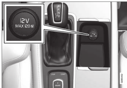
12-V-Steckdose in der Tunnelkonsole, vorn.
