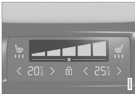
Gebläseregler auf dem hinteren Klima-Bedienfeld an der Tunnelkonsole.
