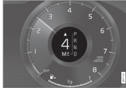
Schaltanzeige auf dem 12-Zoll-Fahrerdisplay bei großem Wählhebel*.
