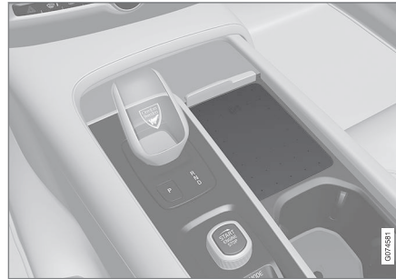
Drahtlos-Telefonladegerät in der Tunnelkonsole.
