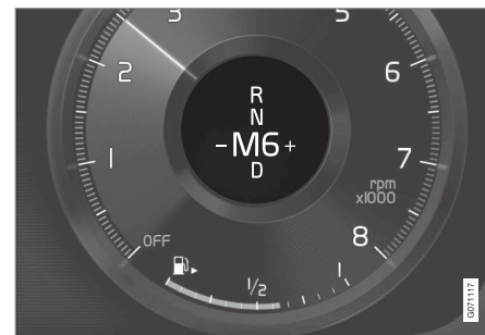
Schaltmuster auf dem Fahrerdisplay bei kleinem Wählhebel.
