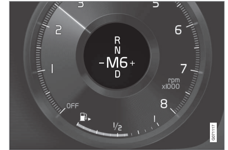
Schaltanzeige auf dem 12-Zoll-Fahrerdisplay bei kleinem Wählhebel*.
