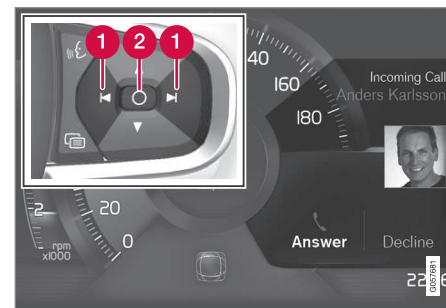
Beispiel für Meldung auf dem Fahrerdisplay 4 und rechtem Lenkradtastenfeld.
