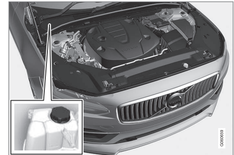
Ausgleichsbehälter der Kühlanlage, Rechtslenker
