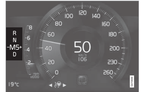
Schaltanzeige auf dem 8-Zoll-Fahrerdisplay bei kleinem Wählhebel.
