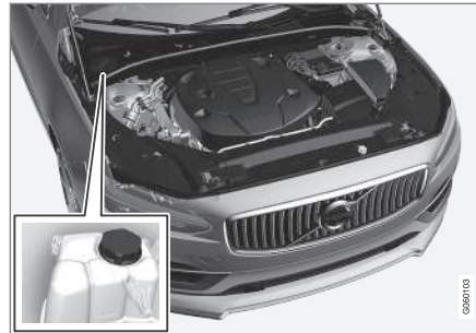
Ausgleichsbehälter der Kühlanlage, Linkslenker
