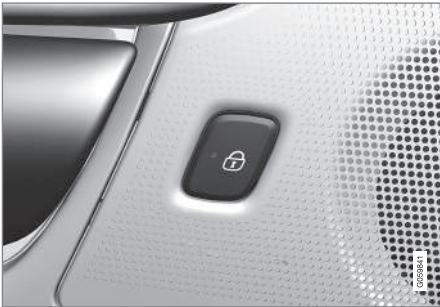
Verriegelungstaste mit Anzeigeleuchte an der Fondtür.
