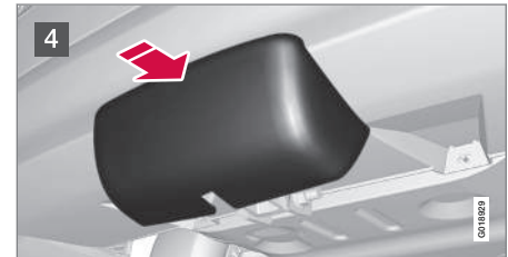
4 Die Schutzkappe aufschieben, bis sie festschnappt.
