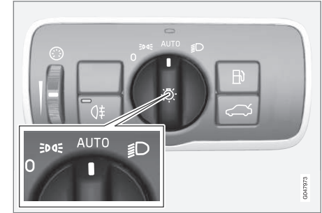
Drehregler des Lichtschalters in Stellung AUTO .
