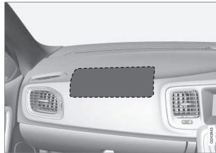
Position des Beifahrerairbags in Rechtslenkern.
