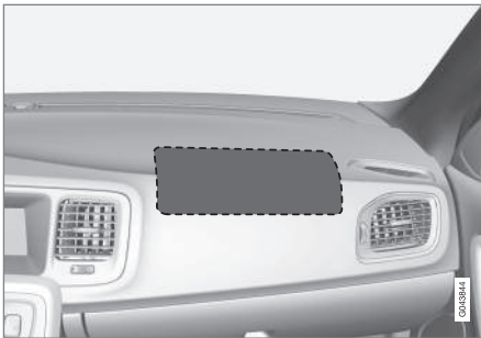
Position des Beifahrerairbags in Linkslenkern.
