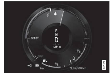
Fahrerdisplay bei Antrieb durch Elektro- und Verbrennungsmotor.
