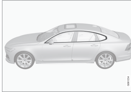
Teile, die mit Reinigungsmitteln mit einem pH-Wert zwischen 3,5 und 11,5 gereinigt werden sollten.
