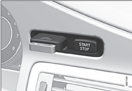
Zündschloss mit Transponderschlüssel, Start- und Stoptaste (weitere Informationen siehe S. 65)
