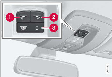
Regler für Leseleuchten und vordere Deckenbeleuchtung
