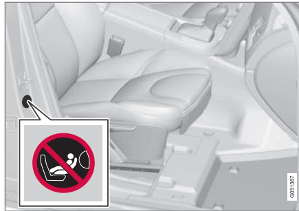
Aufkleber an der Türsäule auf Beifahrerseite. Der Aufkleber ist zu sehen, wenn die Beifahrertür geöffnet wird.
