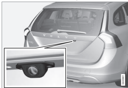
Position der Kamera am Öffnungsgriff.
