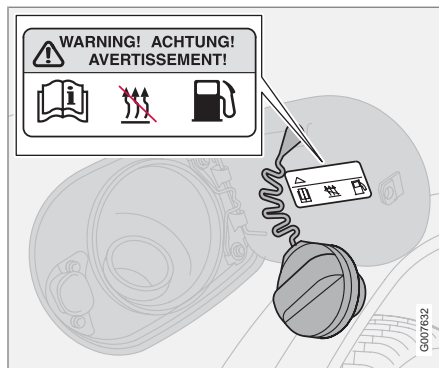
Warnaufkleber auf der Kraftstofftankklappe.
