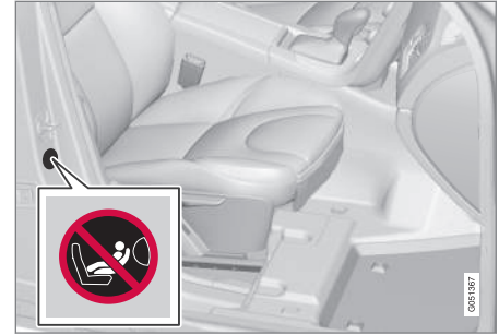
Möglichkeit 2: Airbagaufkleber an der Türsäule auf Beifahrerseite. Der Aufkleber ist zu sehen, wenn die Beifahrertür geöffnet wird.
