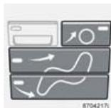
Durch Drücken der Luftverteilungstasten wird der Luftstrom je nach Wunsch zu den Scheiben, in den Innenraum oder zum Boden verteilt.
