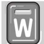
Mit der **W**-Taste am Wählhebel wird das Winterprogramm **W** ein- und ausgeschaltet. Im Kombinationsinstrument wird das Symbol **W** angezeigt, wenn
