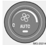
Die AUTO -Funktion übernimmt die automatische Regelung der Klimaanlage, so dass die gewählte Temperatur erreicht wird. Die automatische Funktion steuert Wärme, Klimaanlage, Gebläsegeschwindigkeit, Umluftfunktion und Luftverteilung. Nehmen Sie manuelle Einstellungen für eine oder mehrere Funktionen vor, werden die übrigen Funktionen weiterhin automatisch gesteuert. Indem Sie auf AUTO drücken, werden sämtliche manuellen Einstellungen deaktiviert. Das Display zeigt AUTO KLIMA.
