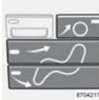
8704217    | Luft strömt zu den Scheiben, aus den Belüftungsdüsen im Armaturenbrett und zum Boden.                          | Für angenehmere Temperaturen im Fußbereich oder wärmere Temperaturen oben bei kalten oder warmen Außentemperaturen. |
