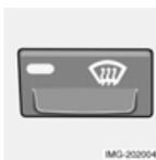
IMG-202004 | Luft strömt zu den Scheiben. Ein Teil der Luft strömt aus den Belüftungsdüsen. Die Luft wird nicht umgewälzt. Die Klimaanlage ist eingeschaltet. | Schnelles Entfernen von Eis und Beschlag.                                                               |
