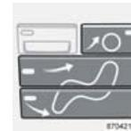
Durch Drücken der Luftverteilungstasten wird der Luftstrom je nach Wunsch zu den Scheiben, in den Innenraum oder zum Boden verteilt.
