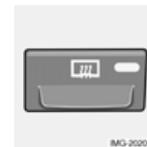
Verwenden Sie diese Funktion, um schnell Eis und Beschlag an der Heckscheibe und den Rückspiegeln zu entfernen.
