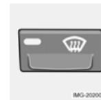
Verwenden Sie diese Funktion, um schnell etwaigen Beschlag und Eis an der Windschutzscheibe und den Seitenscheiben zu entfernen. Die Luft wird mit
