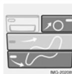
IMG-202089 | Luft strömt zum Boden und zu den Scheiben. Ein Teil der Luft strömt aus den Belüftungsdüsen im Armaturenbrett. | Für angenehme Temperaturen im Innenraum und beschlagfreie Scheiben bei kalten Außentemperaturen.                    |
