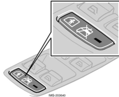
*Fensterhebersperre hinten und elektrische Kindersicherung<sup>1</sup>*
