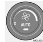
Mit dem Drehregler erhöhen oder senken Sie die Gebläsegeschwindigkeit. Die Gebläsedrehzahl wird automatisch geregelt, wenn AUTO ausgewählt wird. Die zuvor eingestellte Geschwindigkeit wird deaktiviert.
