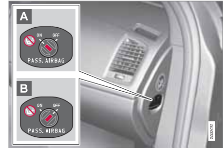
Position des Schalters.
