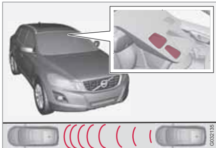
Sender- und Empfängerfenster des Lasersensors.
