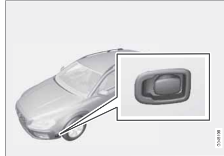
Steckdose für Motorheizung.
