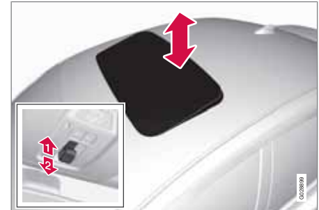
Vertikales Öffnen, an der Hinterkante nach oben.
