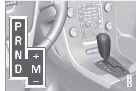
D: Automatische Gangstellungen. M (+/-): Manuelle Gangstellungen.
