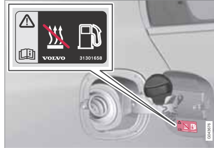
Warnaufkleber auf der Kraftstofftankklappe.
