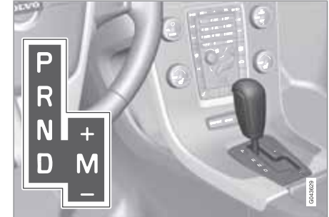
D: Automatische Gangstellungen. M (+/-): Manuelle Gangstellungen.
