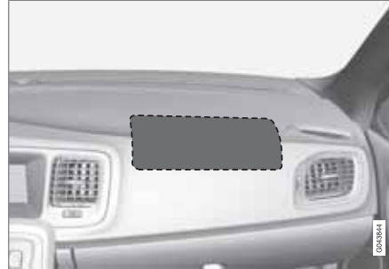
Position des Beifahrerairbags in Linkslenkern.
