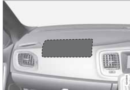
Position des Beifahrerairbags in Rechtslenkern.
