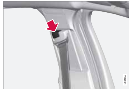
Höheneinstellung des Sicherheitsgurtumlenkers. Die Taste eindrücken und den Umlenker in der Höhe verstellen. Den Umlenker so hoch wie möglich positionieren, ohne dass der Gurt den Hals berührt.
