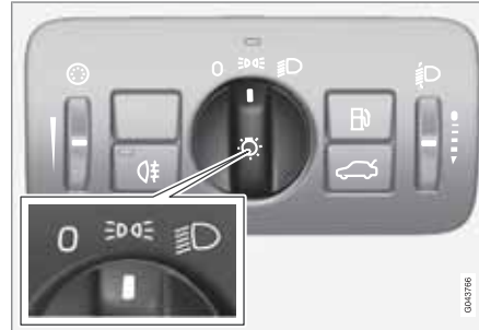
Lichtschalter in Stellung für Positionsluchten/Standlicht.
