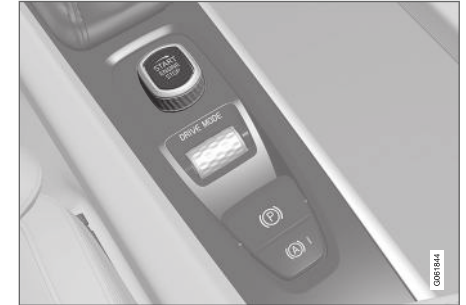
Startschalter auf der Tunnelkonsole.
