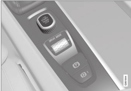
Startschalter auf der Tunnelkonsole.
