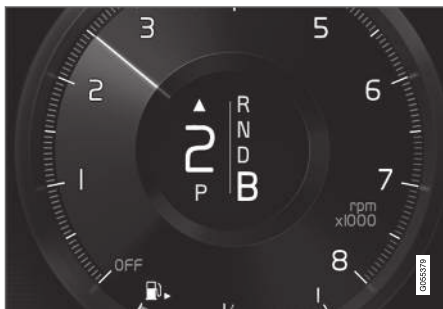
Schaltanzeige im Fahrerdisplay 5 .
