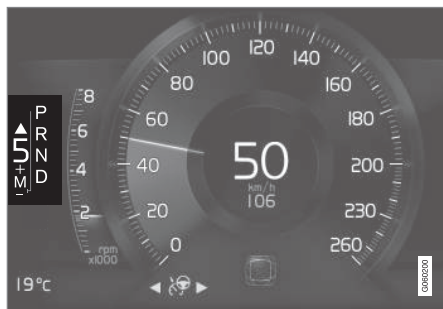
Schaltanzeige auf dem 8-Zoll-Fahrerdisplay bei großem Wählhebel.
