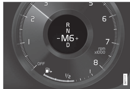
Schaltanzeige auf dem 12-Zoll-Fahrerdisplay bei kleinem Wählhebel*.
