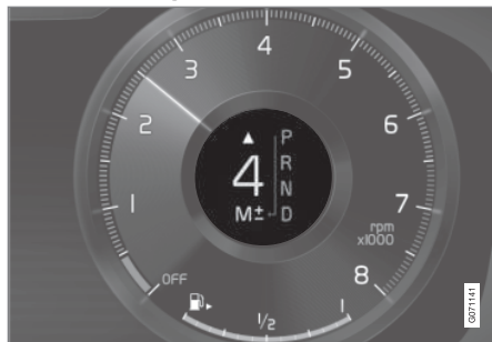
Schaltanzeige auf dem 12-Zoll-Fahrerdisplay bei großem Wählhebel*.
