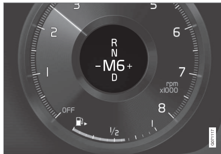
Übersicht über manuellen Schaltmodus auf dem Fahrerdisplay.
