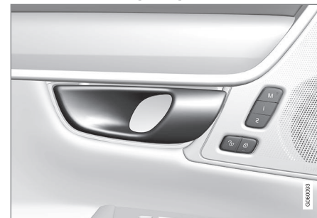
Griff zum alternativen Entriegeln der Tür 11 .
