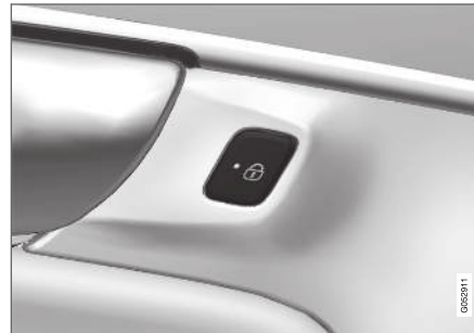
Verriegelungstaste mit Anzeigeleuchte an der Hintertür.
