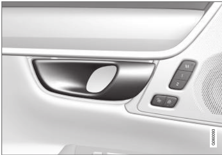
Griff zum alternativen Entriegeln der Tür 12 .
