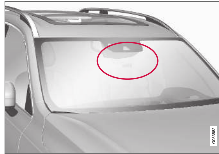
Platzierung der Radareinheit.
