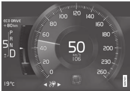
Eco-Anzeige auf dem 8-Zoll-Fahrerdisplay.
