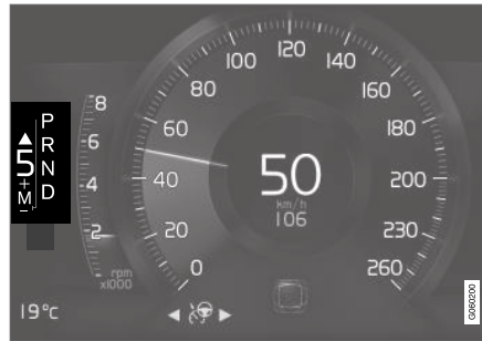
Schaltanzeige auf dem 8-Zoll-Fahrerdisplay.
