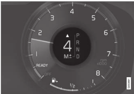
Schaltanzeige auf dem 12-Zoll-Fahrerdisplay*.
