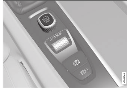
Startschalter auf der Tunnelkonsole.
