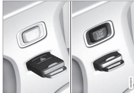
Zündschloss mit herausgezogenem/ingedrücktem Transponderschlüssel und START/STOP ENGINE -Taste
