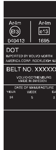
Kennzeichnung an Sicherheitsgurten mit Gurtstraffer.
