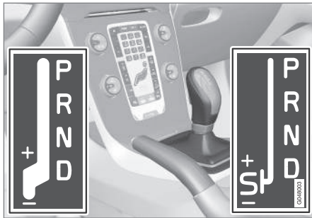
D: Automatische Gangstellungen. +/-: Manuelle Gangstellungen. S: Sportmodus 7 .
