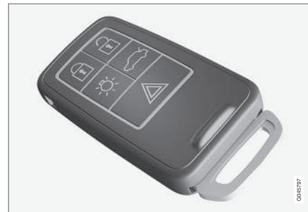
Transponderschlüssel in Basisausführung.
