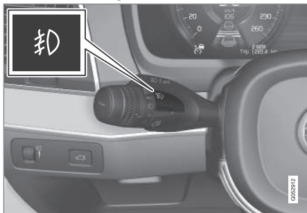
Taste für Nebelscheinwerfer.
