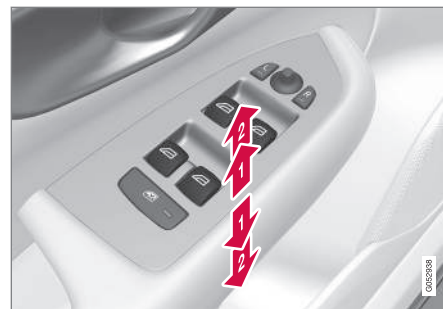
Betätigung der Fensterheber.
