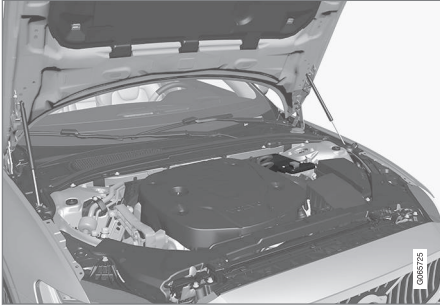
Die 12 V-Unterstützungsbatterie befindet sich im Motorraum.
