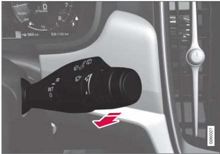
Waschfunktion, rechter Lenkradhebel.
