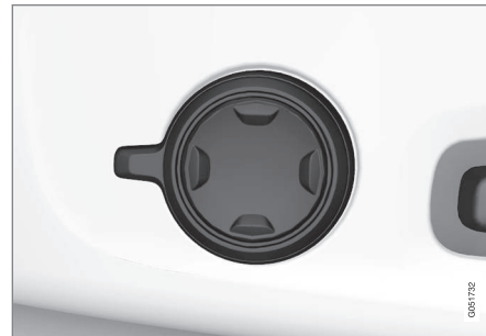
Seitlich am Sitzpolster angebrachter Multifunktionsschalter.
