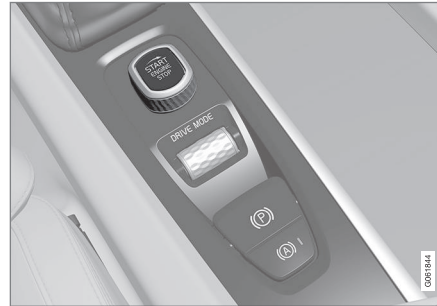
Startschalter auf der Tunnelkonsole.
