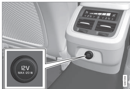
12-V-Steckdose in der Tunnelkonsole, Rücksitz.
