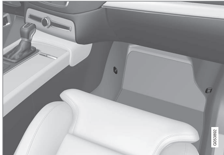
Lage der Befestigungspunkte für den Vordersitz
