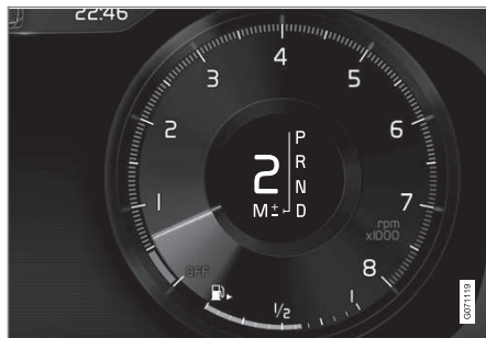
Schaltmuster auf dem Fahrerdisplay bei großem Wählhebel.
