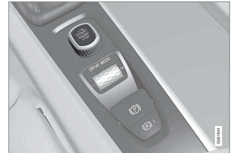
Startschalter auf der Tunnelkonsole.
