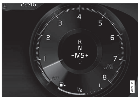
Fahrerdisplay beim Schalten mit Schaltwippen in der Schaltstellung für manuelles Schalten (kleiner Wählhebel).
