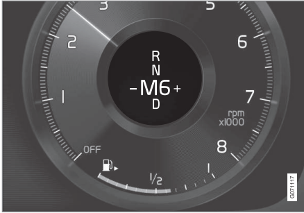
Schaltmuster auf dem Fahrerdisplay bei kleinem Wählhebel.
