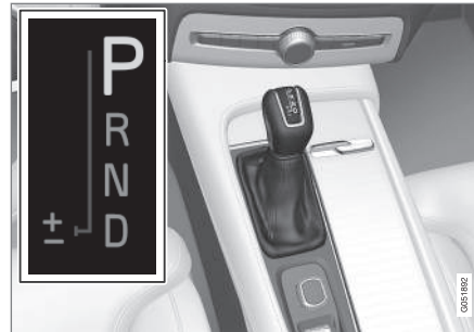
Großer Wählhebel und Schaltmuster auf dem Fahrerdisplay.
