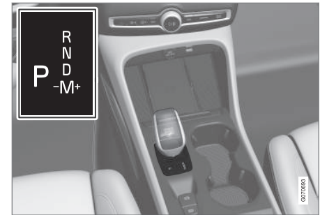
Kleiner Wählhebel und Schaltmuster auf dem Fahrerdisplay
