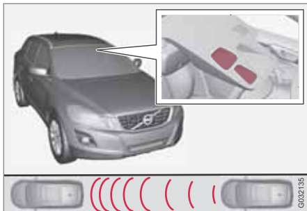
Sender- und Empfängerfenster des Lasersensors 1 .
