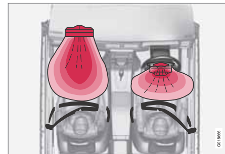
Das Airbagsystem von oben, Rechtslenker.
