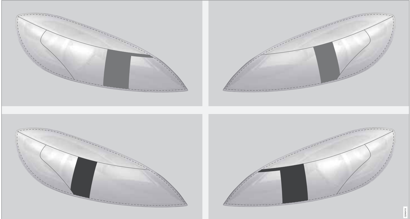
Obere Reihe: Linkslenker, Schablonen A und B. Untere Reihe: Rechtslenker, Schablonen C und D.
