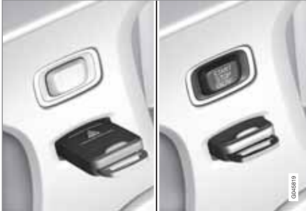
Zündschloss mit herausgezogenem/eingedrücktem Transponderschlüssel.
