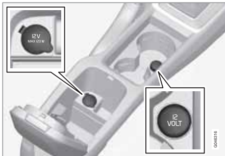
12-V-Steckdose in der Tunnelkonsole, Vordersitz.
