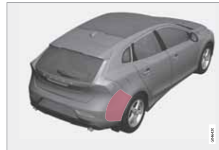
Anordnung der BLIS- und CTA-Sensoren.
