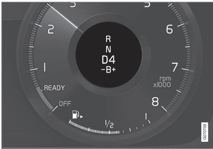
Fahrerdisplay beim Schalten mit den Schaltwippen.
