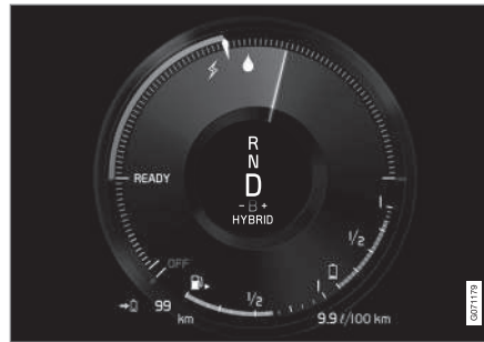
Fahrerdisplay bei Antrieb durch Elektro- und Verbrennungsmotor.
