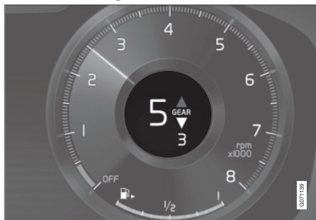
Schaltanzeige auf dem 12-Zoll-Fahrerdisplay*.
