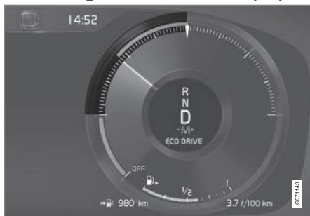
Eco-Anzeige auf dem 12-Zoll-Fahrerdisplay*.
