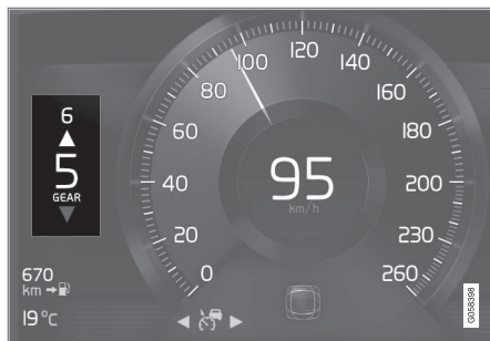
Schaltanzeige auf dem 8-Zoll-Fahrerdisplay.
