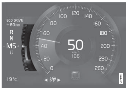
Eco-Anzeige auf dem 8-Zoll-Fahrerdisplay.
