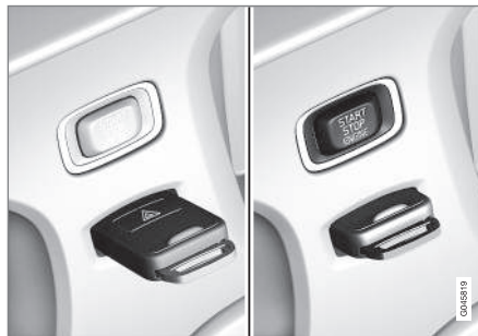
Zündschloss mit herausgezogenem/eingedrücktem Transponderschlüssel und START/STOP ENGINE -Taste
