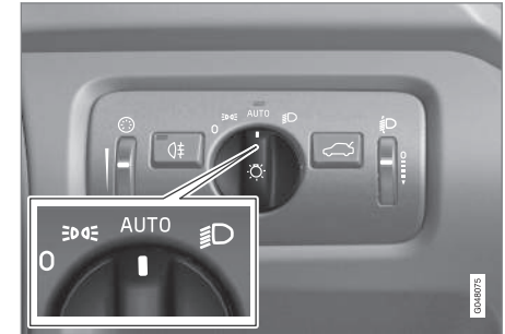
Der Drehregler des Lichtschalters in Stellung für AUTO .
