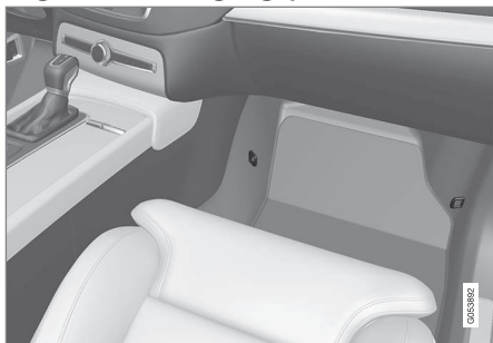
Lage der Befestigungspunkte für den Vordersitz
