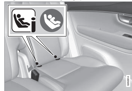
Lage der Befestigungspunkte in der zweiten Sitzreihe.
