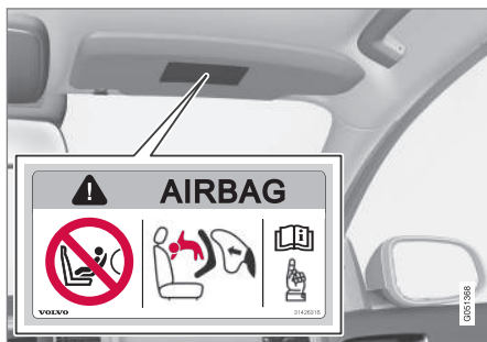
Möglichkeit 1: Airbagaufkleber an der Sonnenblende auf Beifahrerseite.
