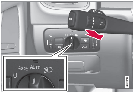
Lenkradhebel und Lichtschalter-Drehregler in Stellung AUTO .
