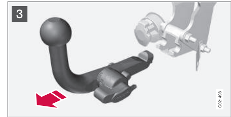
3 Den Verriegelungsknopf vollständig bis zum Anschlag weiterdrehen, herunterdrücken und gleichzeitig die Anhängierzugvorrichtung nach hinten und oben herausziehen.
