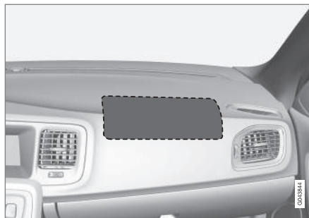
Position des Beifahrerairbags in Linkslenkern.
