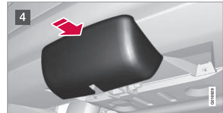
4 Die Schutzkappe aufschieben, bis sie festschnappt.
