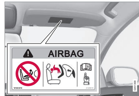
Möglichkeit 1: Airbagaufkleber an der Sonnenblende auf Beifahrerseite.
