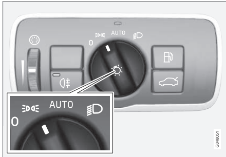
Drehregler des Lichtschalters in Stellung für Positionsluchten/Standlicht.
