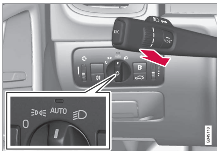
Lenkradhebel und Lichtschalter-Drehregler in Stellung AUTO .
