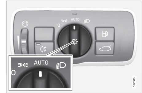
Drehregler des Lichtschalters in Stellung AUTO .
