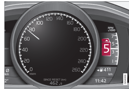
Kombinationsinstrument "Digital" mit Ganganzeige.
