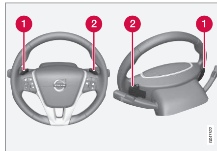
Die beiden "Schaltwippen" des Lenkrads.
